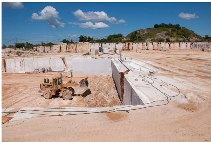
Slika 2-7 Obaranje primarnog bloka u površinskom kopu Kanfanar (Kamen d.d., 2022)
