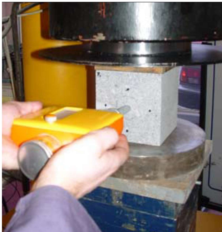
Slika 3-2 Prikaz ispitivanja na granitima Schmidovim čekićem (Vasconcelos i dr., 2007)
