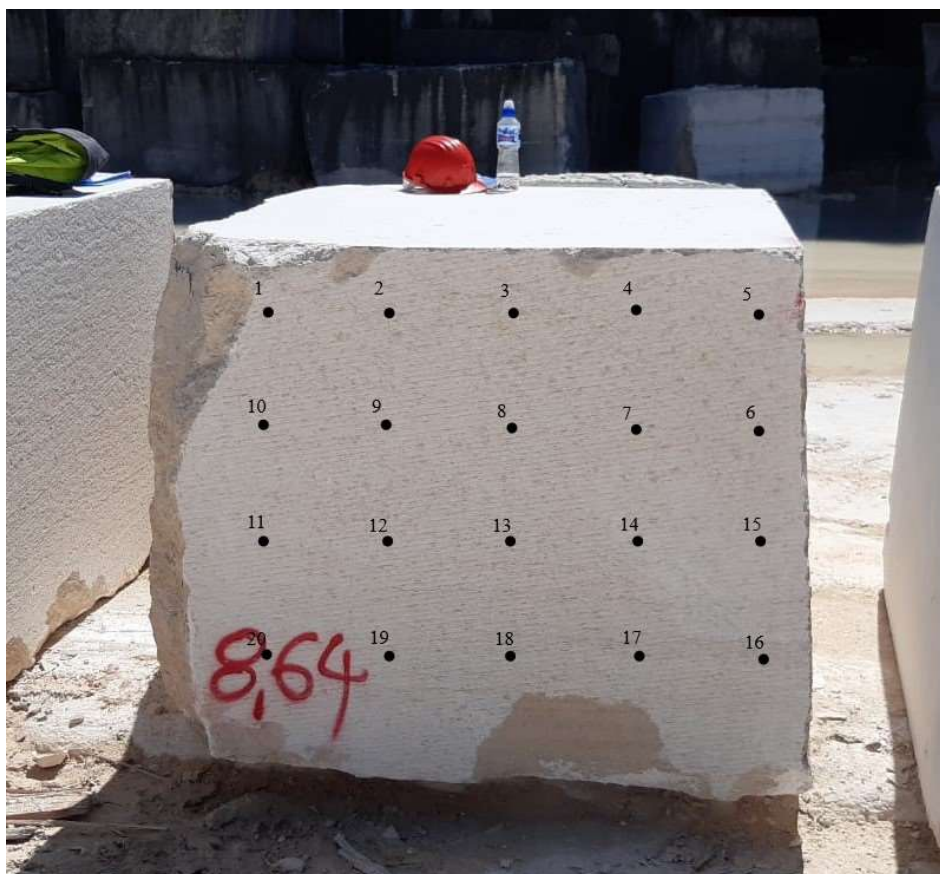
Slika 4-3 Način i redoslijed prilikom raspršenog načina ispitivanja
