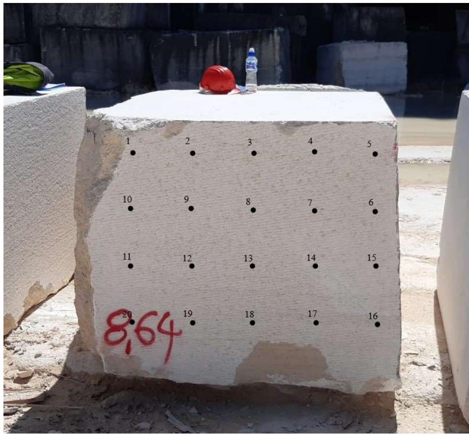
Slika 4-3 Način i redoslijed prilikom raspršenog načina ispitivanja
