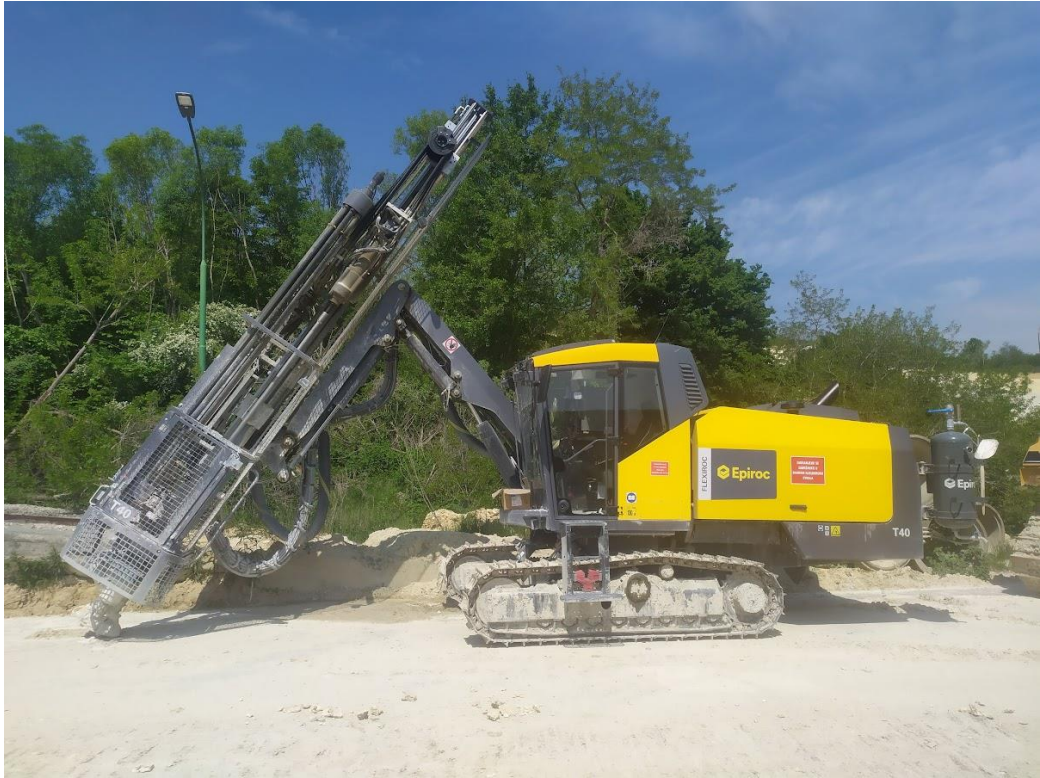
Slika 4-1 Bušilica Epiroc FlexiROC T40
