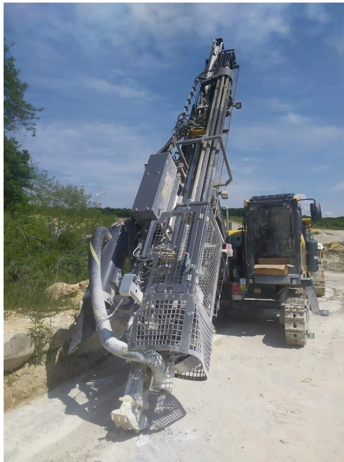
Slika 4-2 Bušilica Epiroc FlexiROC T40
