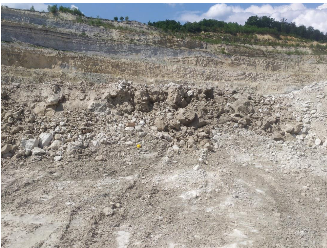
Slika 8-6 Granulacija minskog polja Sivo-bijeli Ø60
