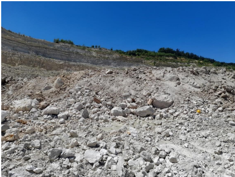
Slika 8-8 Granulacija minskog polja Sivo-bijeli Ø70
