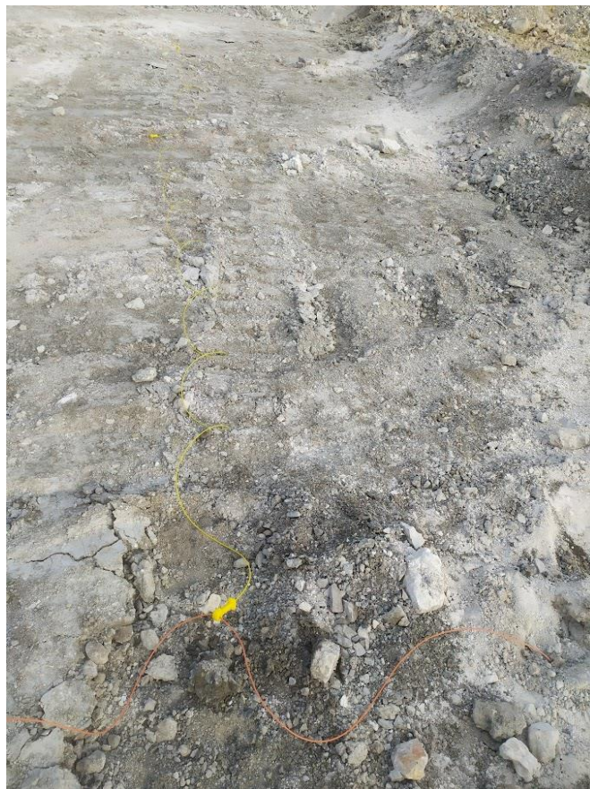
Slika 6-5 Spajanje redova minskih bušotina konektorima (žuto)
