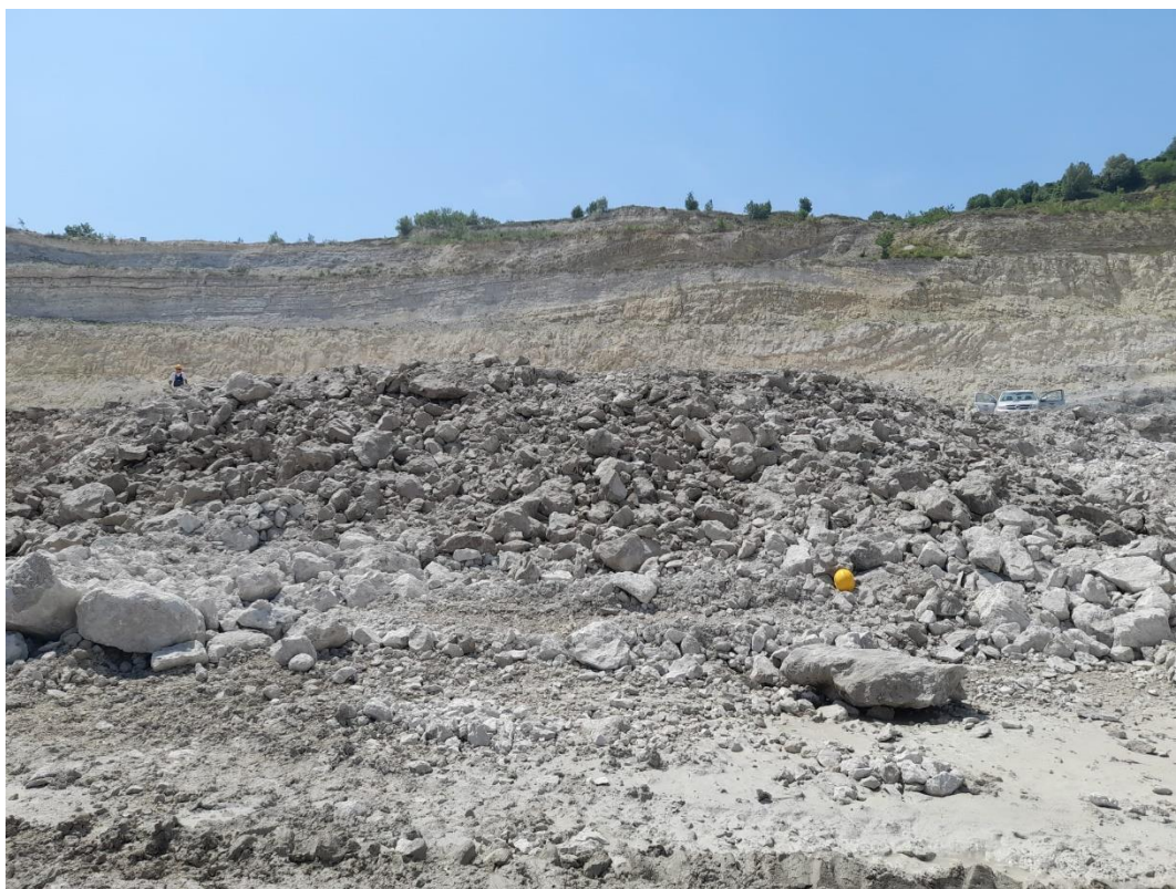
Slika 8-2 Granulacija minskog polja Sivi Ø60
