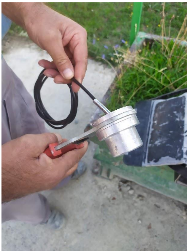
Slika 6-6 Spajanje rudarske kapice br. 8 na sporogoreći štapin
