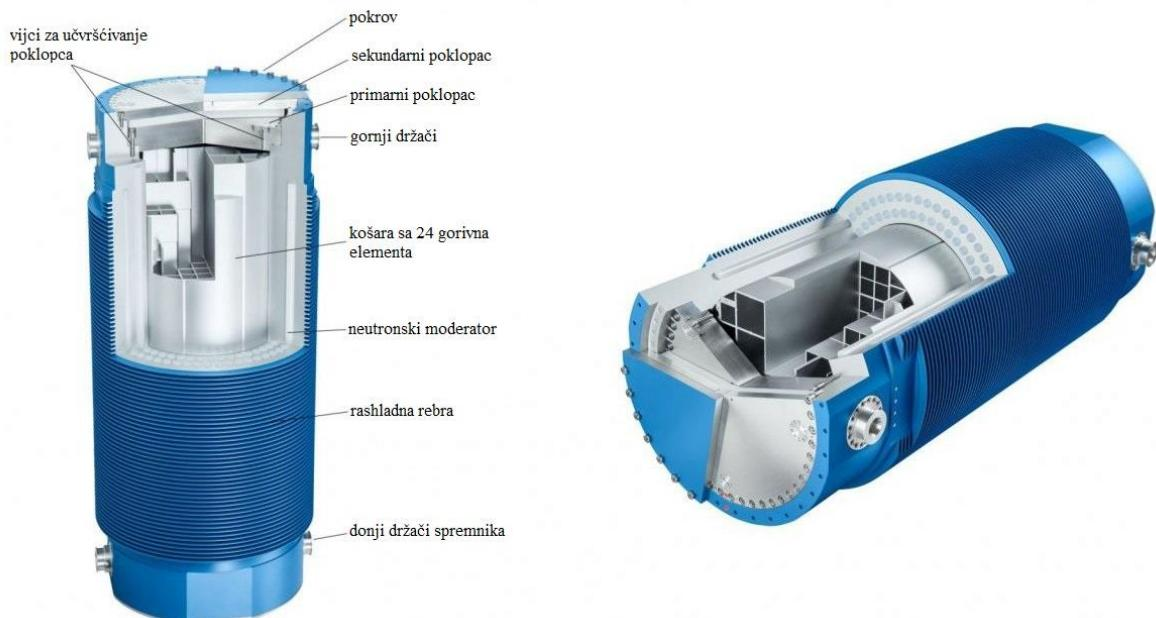
**Slika 2-2.** Dvonamjenski spremnik za skladištenje s košarom za 24 goriva elementa CASTOR V/19 (<https://www.gns.de>, 2022)
