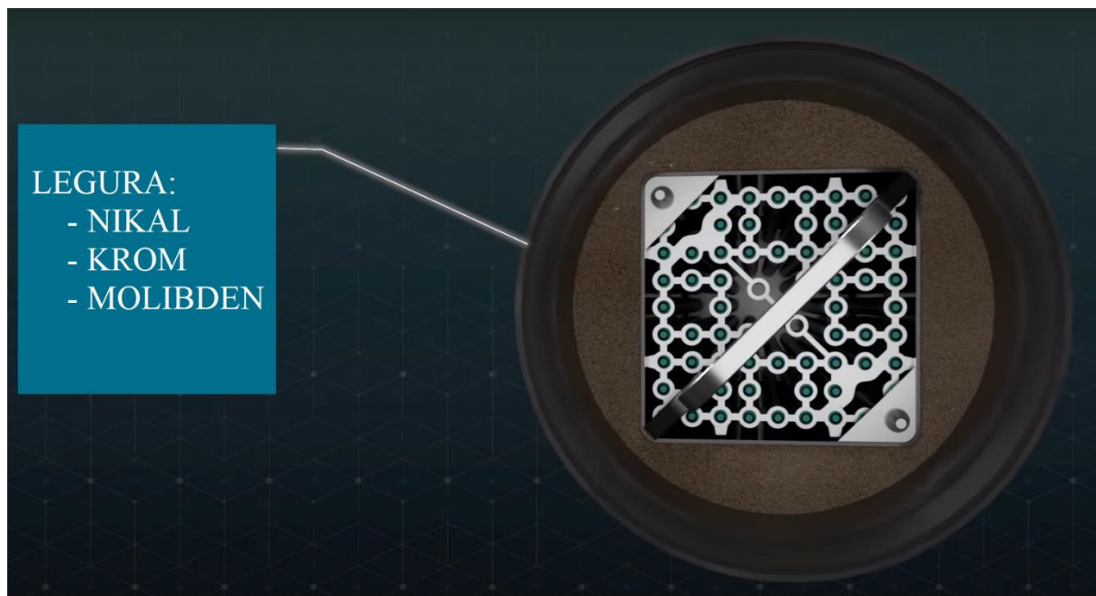
Slika 5-2. Presjek spremnika za odlaganje sa jednim gorivnim elementom (Muller et al., 2019)
