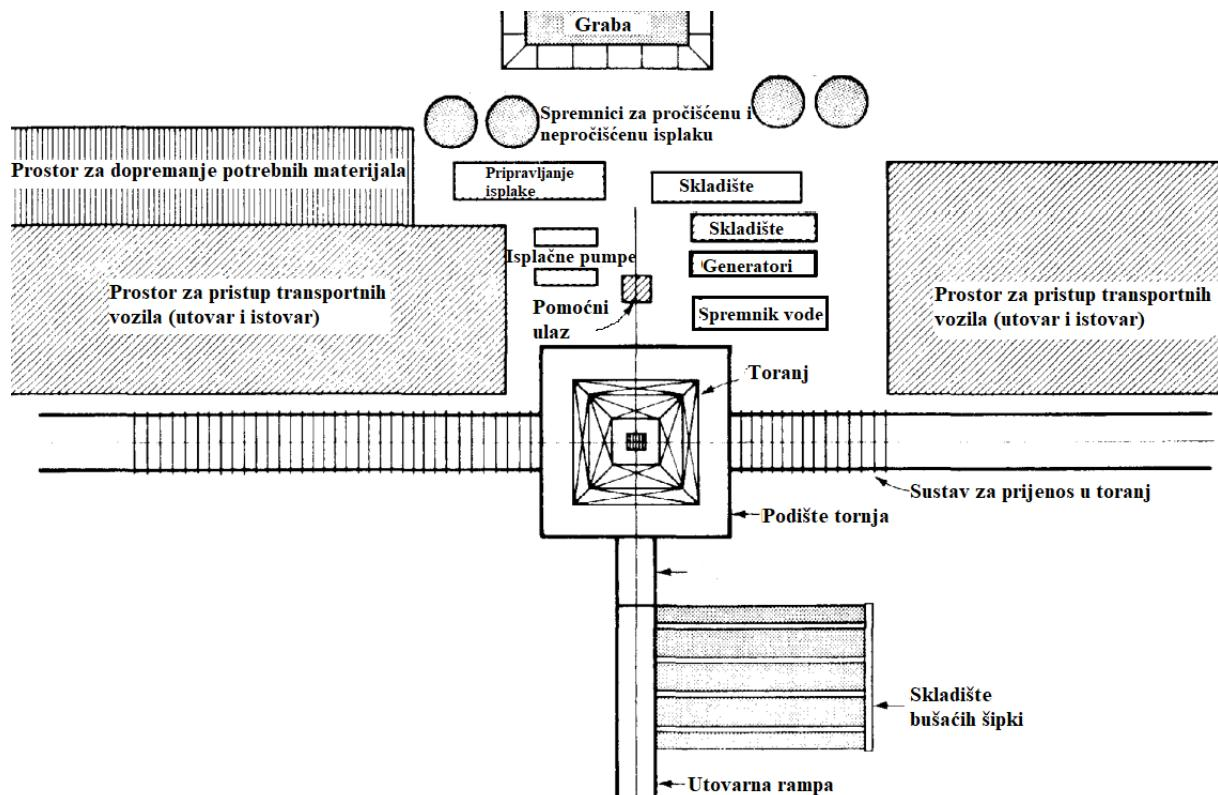
**Slika 4-5.** Shema tlocrta radilišta s nadograđenim sustavom tračnica za prijenos spremnika u toranj (Woodward – Clyde Consultants, 1983)
