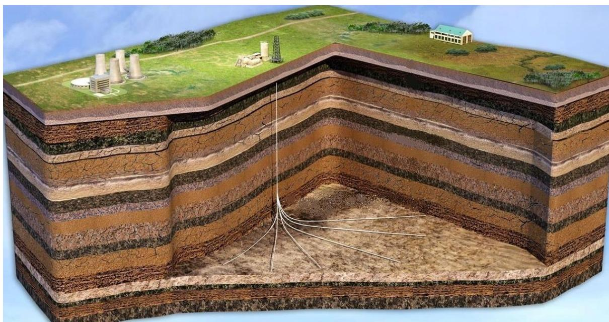
**Slika 5-1.** Shema multilateralnih bušotina izrađenih iz jednog glavnog kanala bušotine
