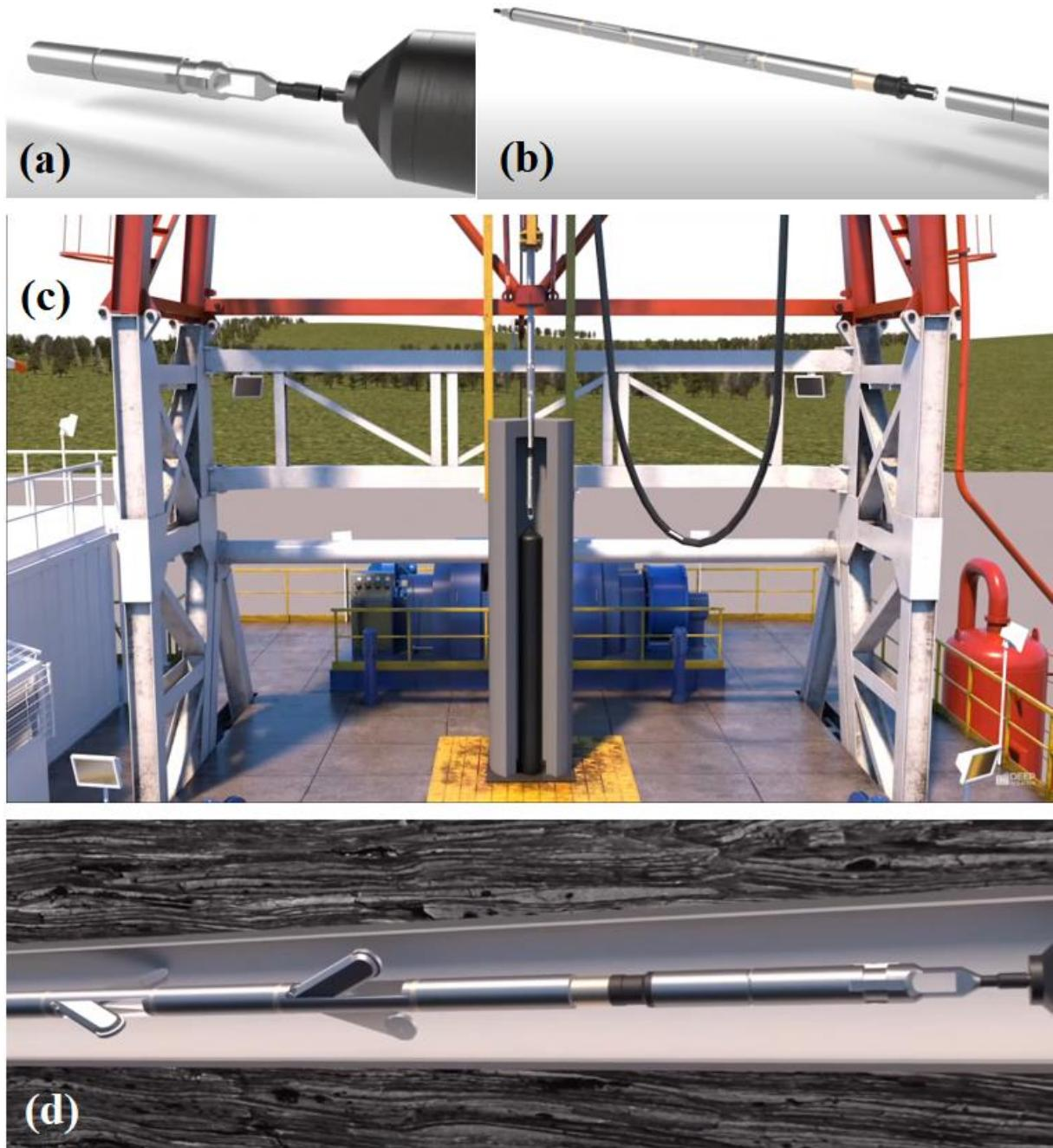
**Slika 5-4.** Spajanje alatke za spuštanje na spremnik za odlaganje (a), spajanje bušotinskog traktora na alatku za spuštanje (b), položaj spremnika u tornju bušačeg postrojenja spremnog za spuštanje u kanal bušotine (c), bušotinski traktor prilikom odlaganja spremnika u horizontalni dio kanala bušotine (d) (Muller et al., 2019)
