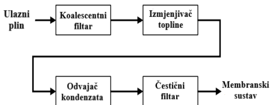
Slika 4-14. Predobrada ulaznog plina (Dortmundt i Doshi, 2003)
