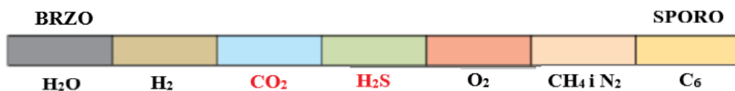
Slika 5-1. Brzina strujanja pojedinih komponenti plina u staklenoj membrani (Gas processing & LNG, 2022)
