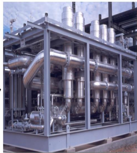
Slika 6-3. Membranske skid-jedinice na Kinder Morganovom SACROC postrojenju za izdvajanje kiselih plinova (Gas Liquids Engineering, 2021)
