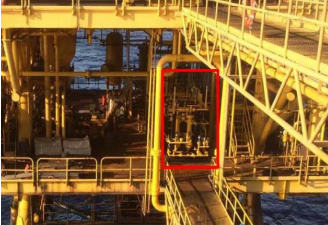
Slika 5-6. Sustav PEEK membrana za kondicioniranje plina kao goriva (Dengel et al., 2019)
