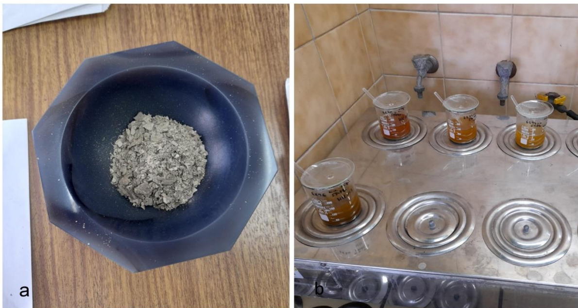
Slika 4.4. a) osušena glinovita frakcija prije homogenizacije, b) tretiranje netopivog ostatka klorovodičnom kiselinom
