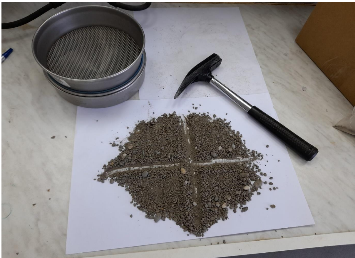
Slika 4.2. Četvrtanje, drobljenje i prosijavanje uzorka tla
