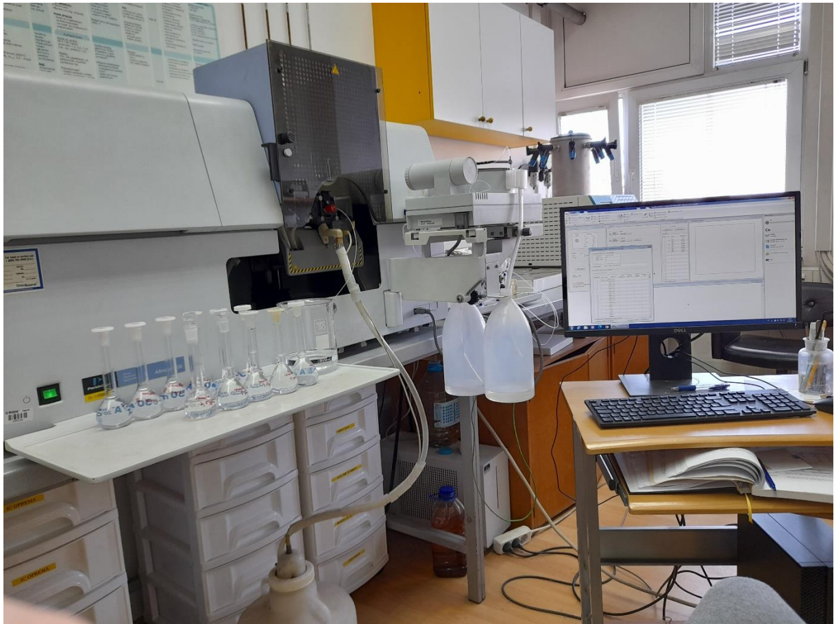
Slika 4.7. Mjerenje koncentracije elemenata plamenom tehnikom na atomskom apsorpcijskom spektrometru Perkins Elmer Analyst 700
