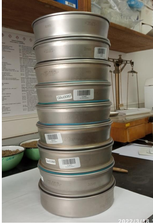
Slika 3–7. Set laboratorijskih sita s otvorom rupica od 4 mm (na vrhu) do 0,032 mm.
