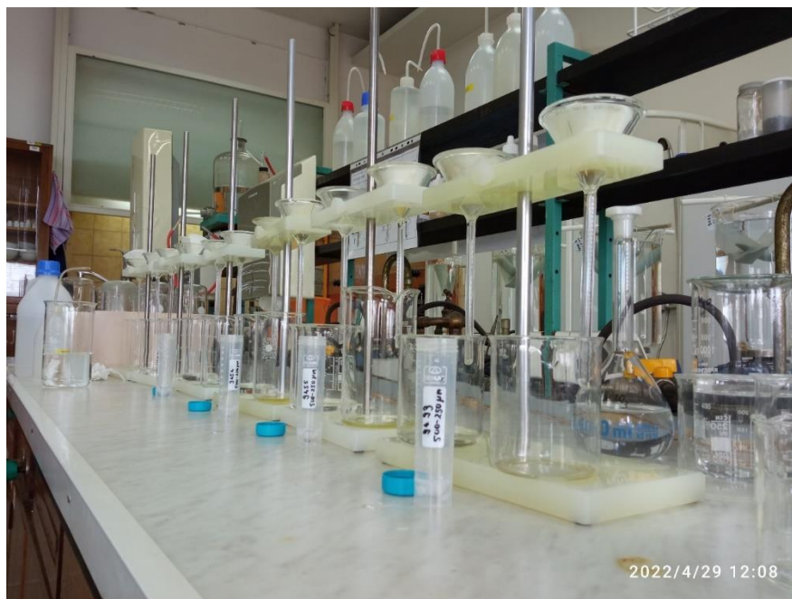
Slika 3–11. Aparatura za separaciju uzorka natrijevim volframatom.
