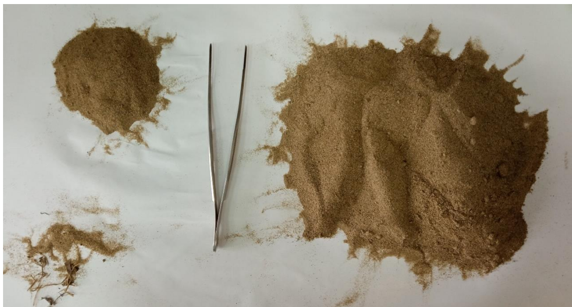
Slika 4-7. Uzorak 9451. Lijevo od pincete se nalazi količina uzorka koja se sijala kroz set laboratorijskih sita, a desno se nalazi ostatak uzorka izdvojen četvrtanjem.
