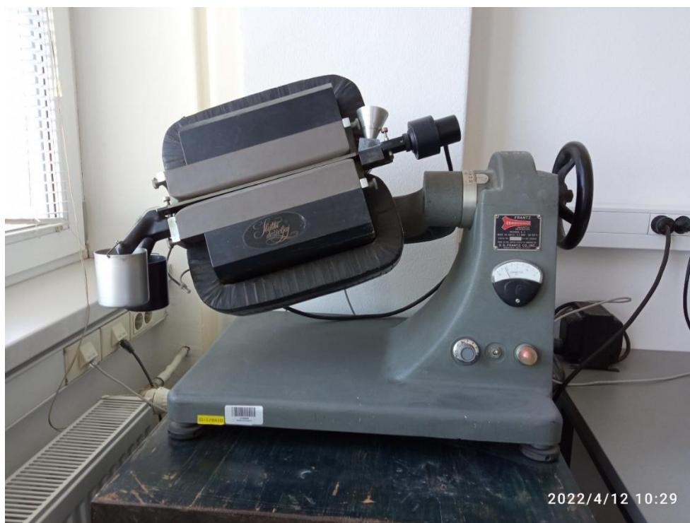
Slika 3–10. Frantzov izodinamski magnetski separator.
