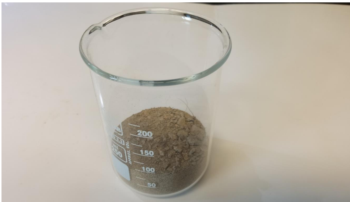
Slika 4–31. Uzorak 9493. U laboratorijskoj čaši se nalazi količina uzorka izdvojena četvrtanjem za sijanje kroz set sita.
