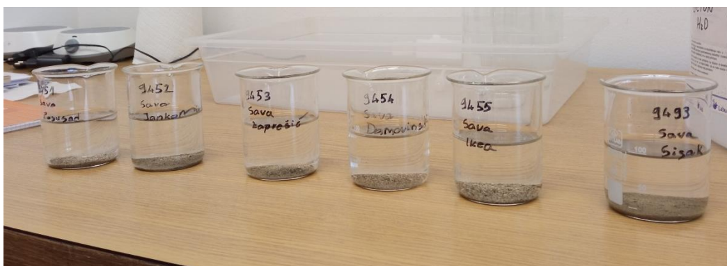
Slika 3–9. Natapanje uzoraka u destiliranoj vodi 24 sata prije mjerenja s Mastersizerom 3000.
