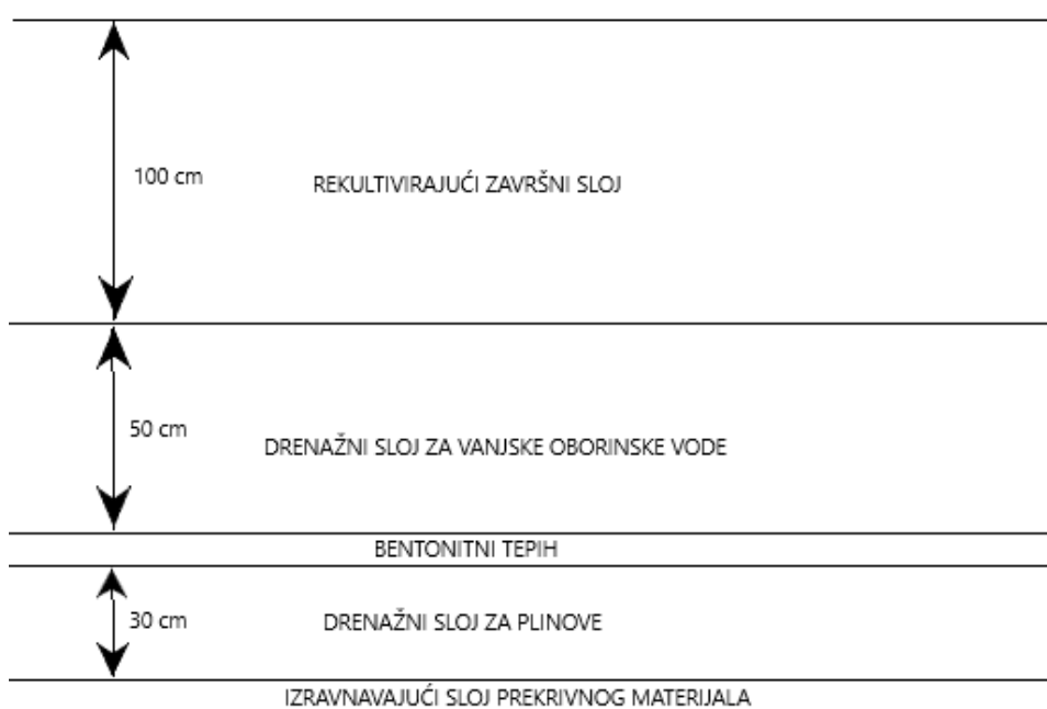
Slika 4-10 Poprečni presjek završnog brtvenog sloja
