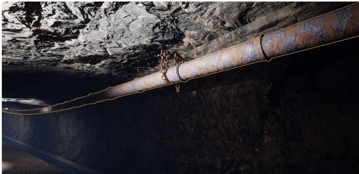
Slika 3-9. Ventilacijska cijev
