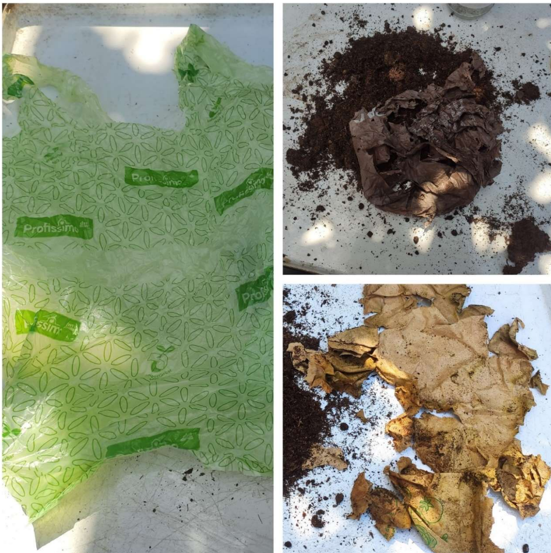
Slika 4-7 Uzorci vrećica nakon dvanaest mjeseci degradacije u zemlji
