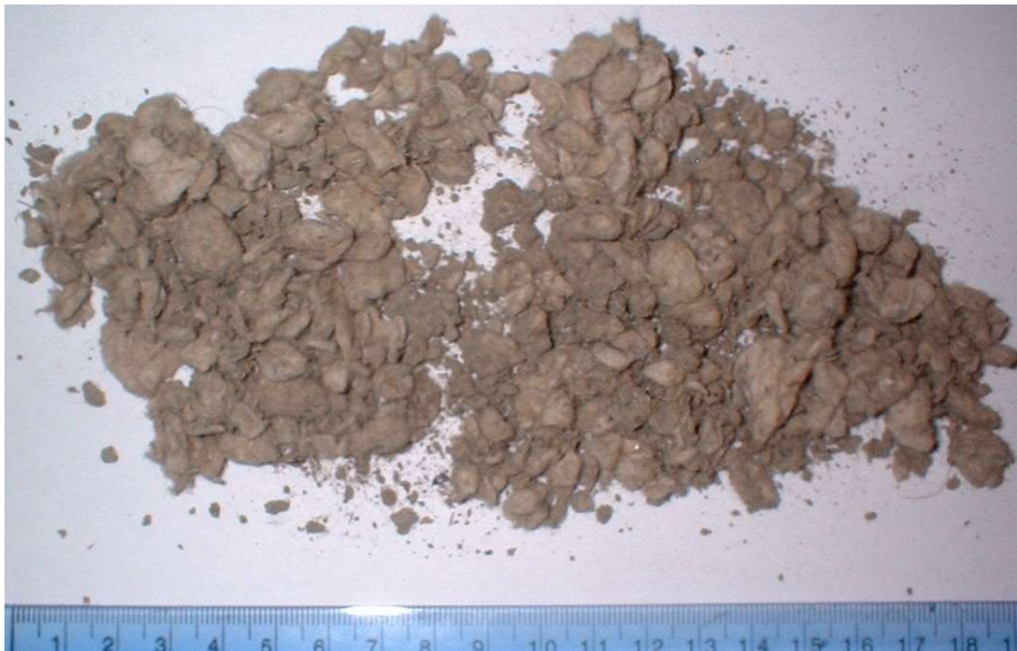
Slika 2-8 Anaerobni digestat (izvor Alex Marshall, Clarke Energy Ltd. 2006)
