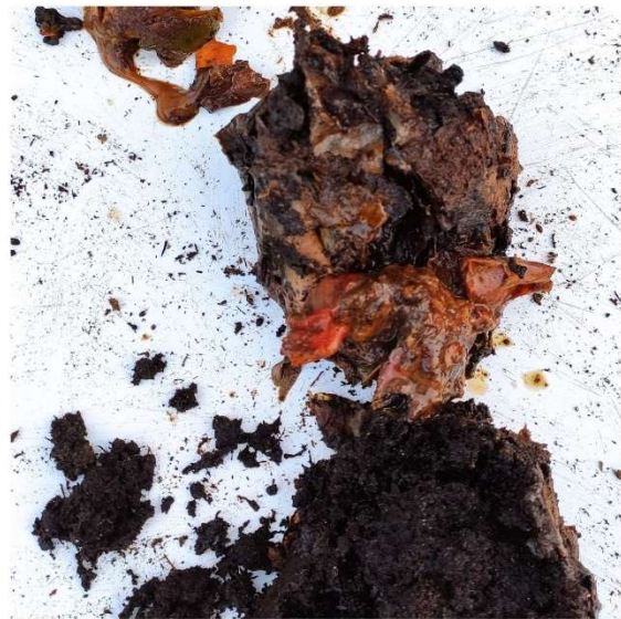
Slika 4-3 Uzorci vrećica nakon tri mjeseca degradacije u biootpadu
