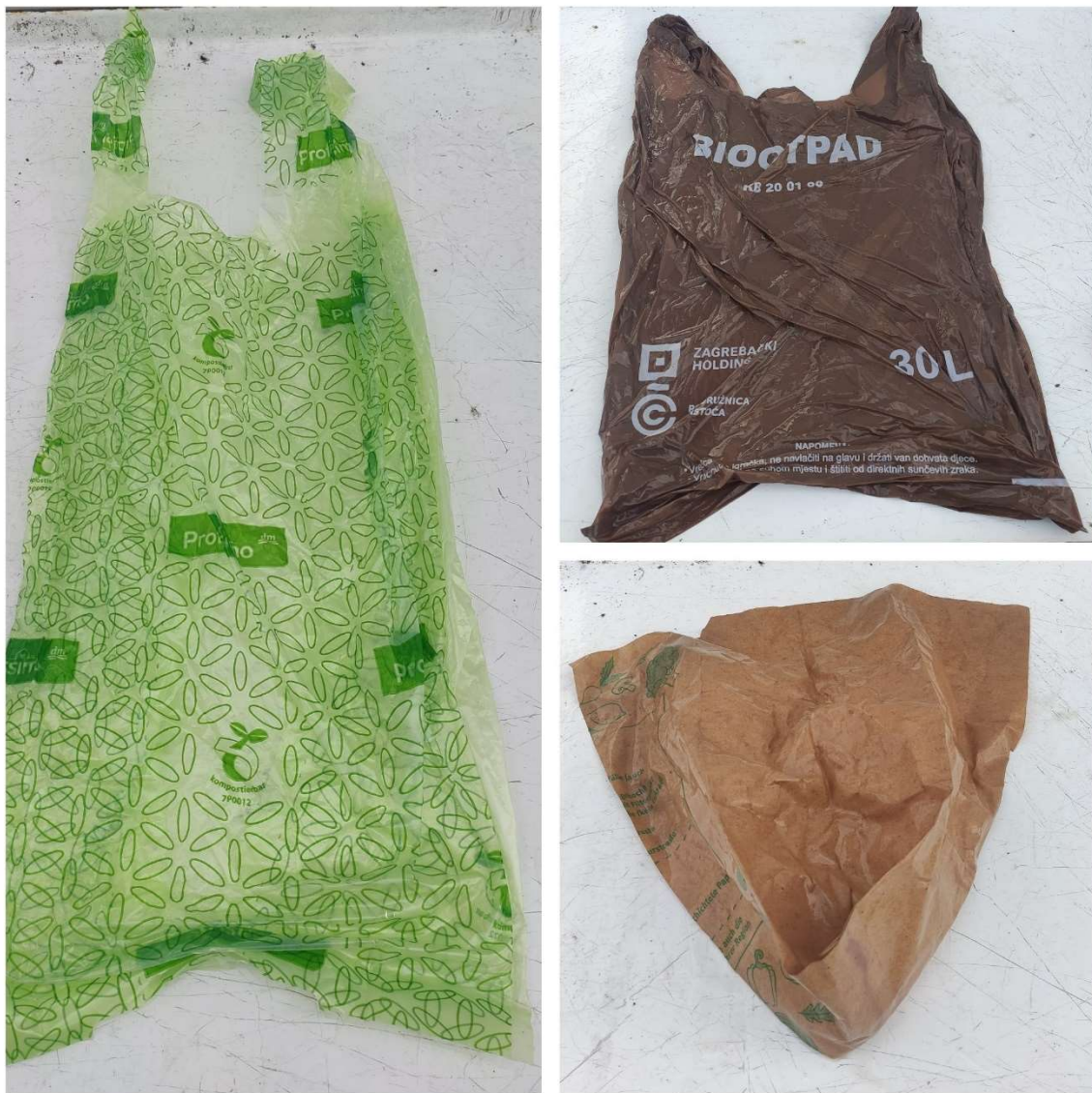
Slika 4-4 Uzorci vrećica nakon šest mjeseci degradacije u vodi
