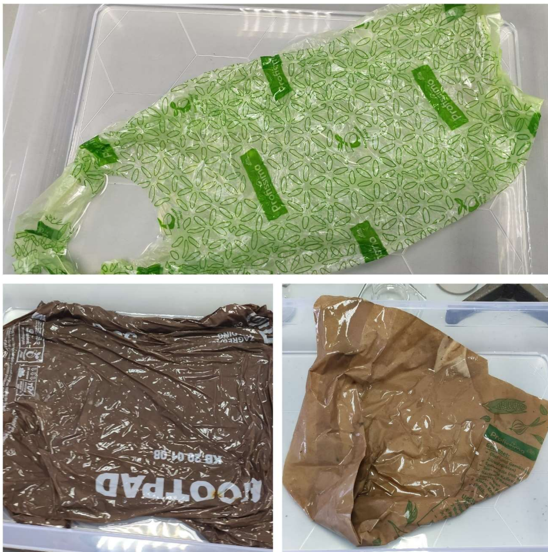
Slika 4-9 Uzorci vrećica nakon dvanaest mjeseci degradacije u vodi
