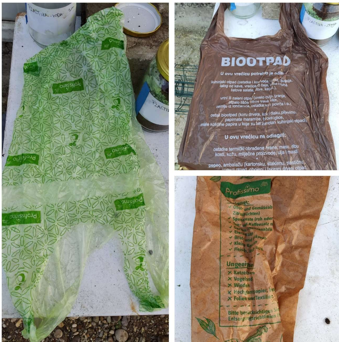
Slika 4-1 Uzorci vrećica nakon 3 mjeseca degradiranja u vodi
