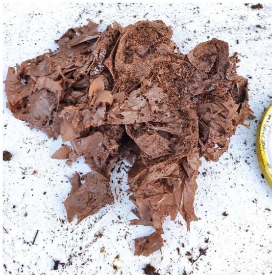
Slika 4-3 Uzorci vrećica nakon tri mjeseca degradacije u biootpadu
