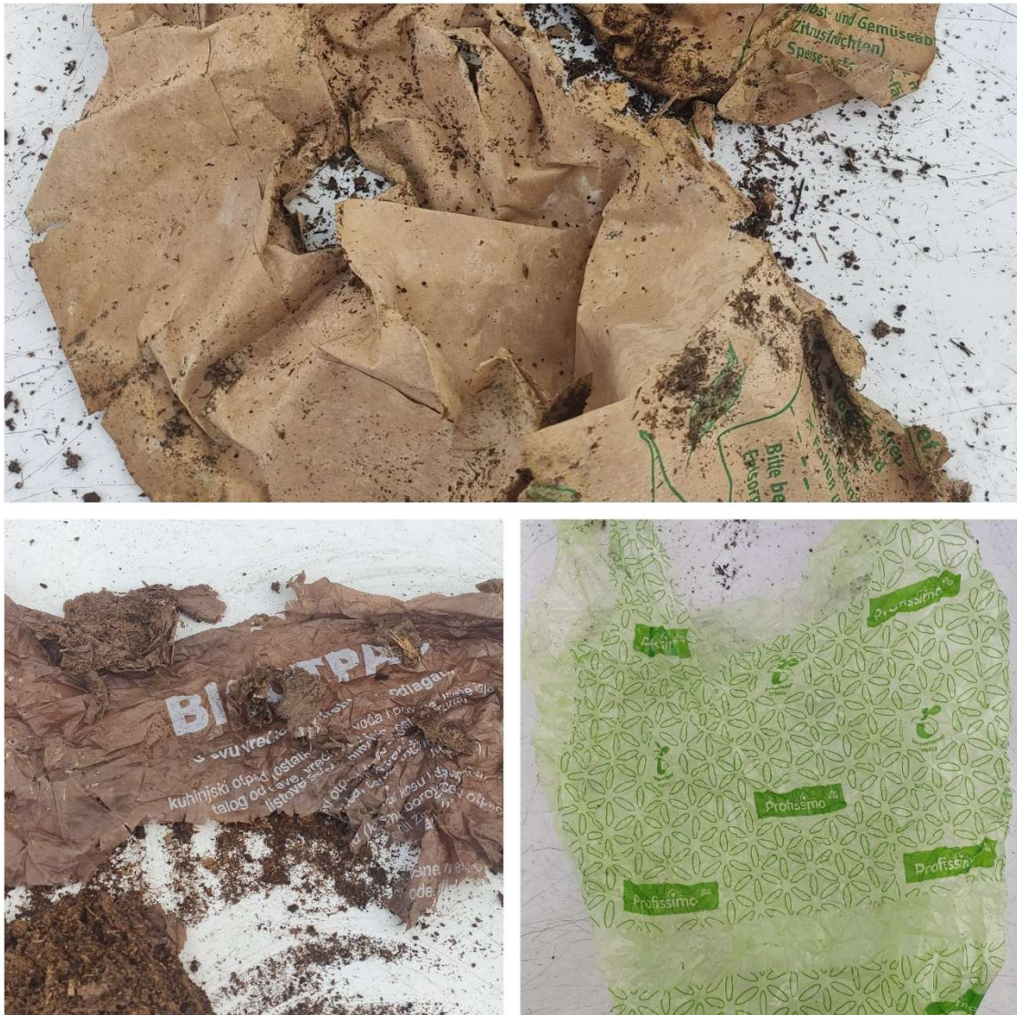
Slika 4-5 Uzorci vrećica nakon šest mjeseci degradacije u zemlji
