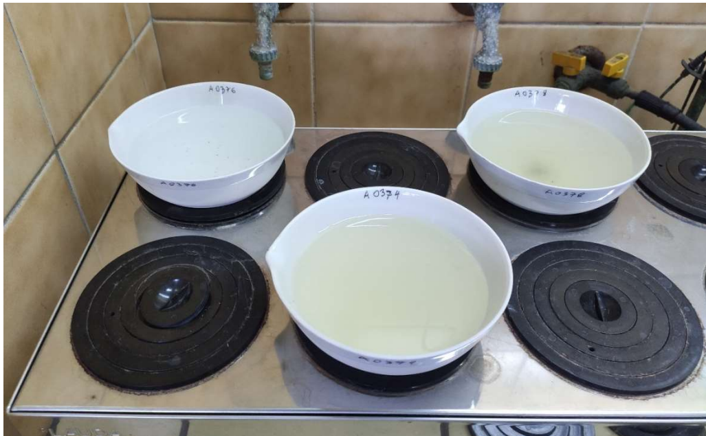
Slika 4-12 Uzorci tekućine na vodenoj kupelji
