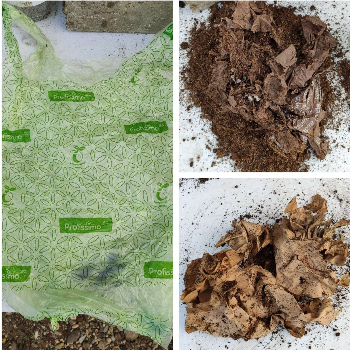
Slika 4-2 Uzorci vrećica nakon tri mjeseca degradacije u zemlji
