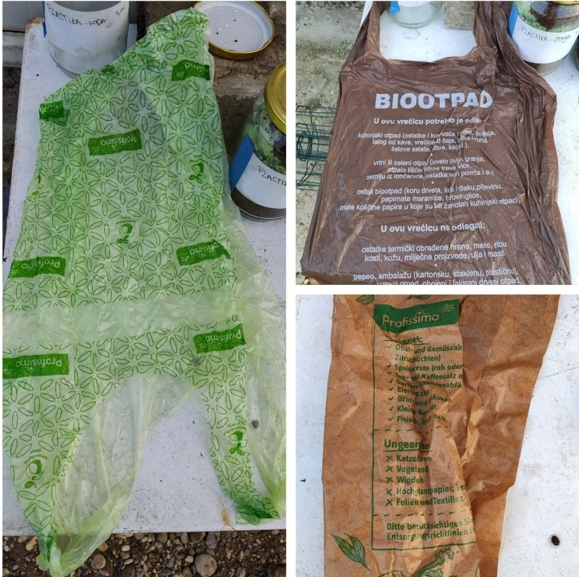
Slika 4-1 Uzorci vrećica nakon 3 mjeseca degradiranja u vodi
