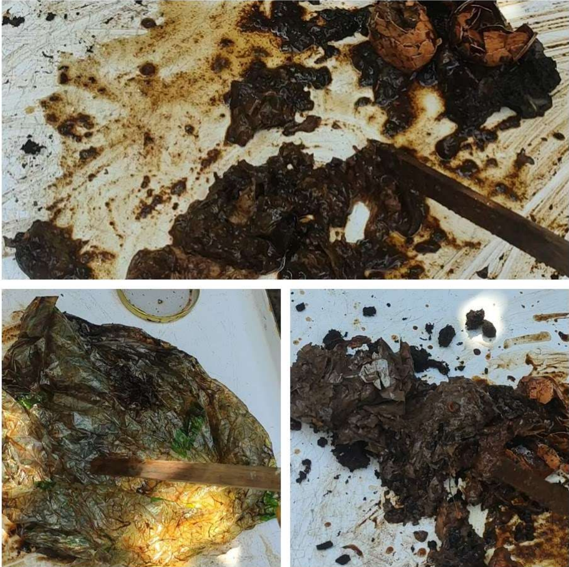
Slika 4-8 Uzorci vrećica nakon dvanaest mjeseci degradacije u biootpadu
