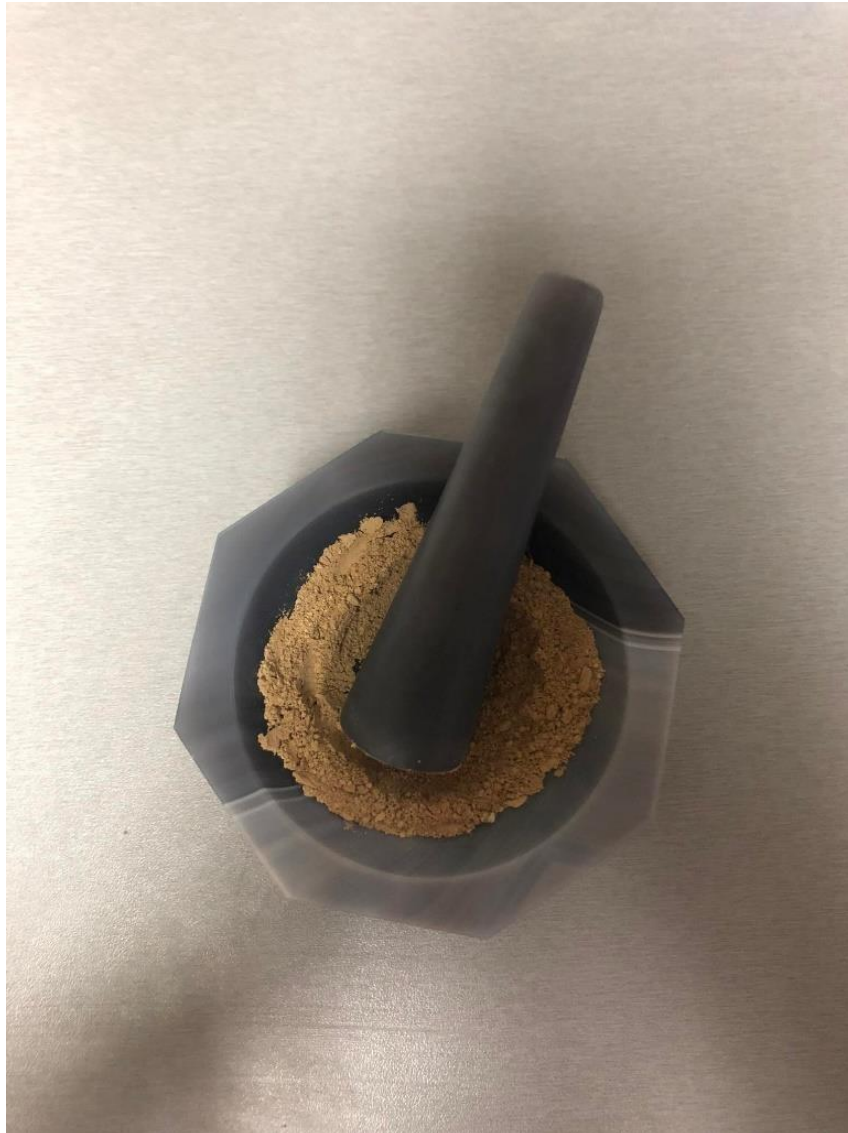
Slika 4.2. Uprašivanje uzorka u ahatnom tarioniku.
