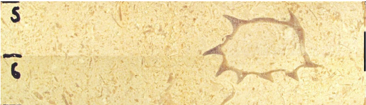
Slika 5.10 Uvećanje plašta uzorka VAL-F-A-UCS-5, na kojem nisu uočeni defekti.
