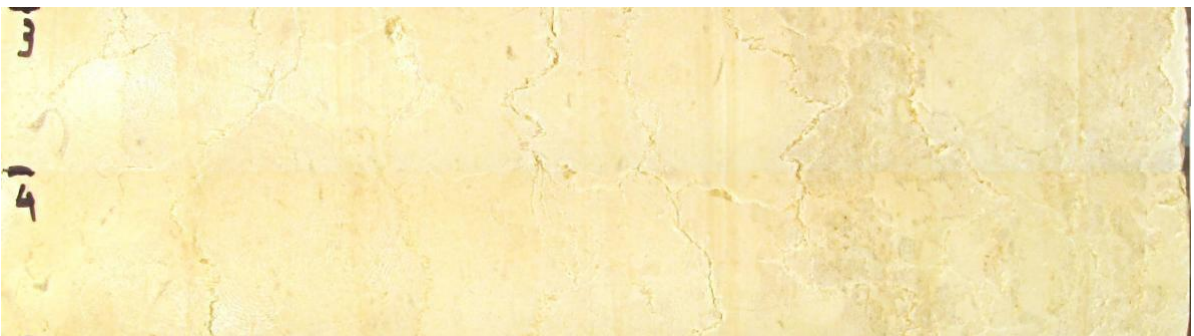
Slika 5.8 Uvećanje plašta uzorka SEL-T-A-UCS-5, čiji je intenzitet raspucanosti okarakteriziran kao izražen.
