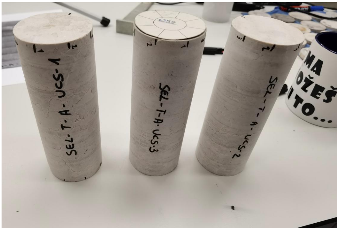
Slika 3.3 Uzorci s označenim intervalima za slikanje.
