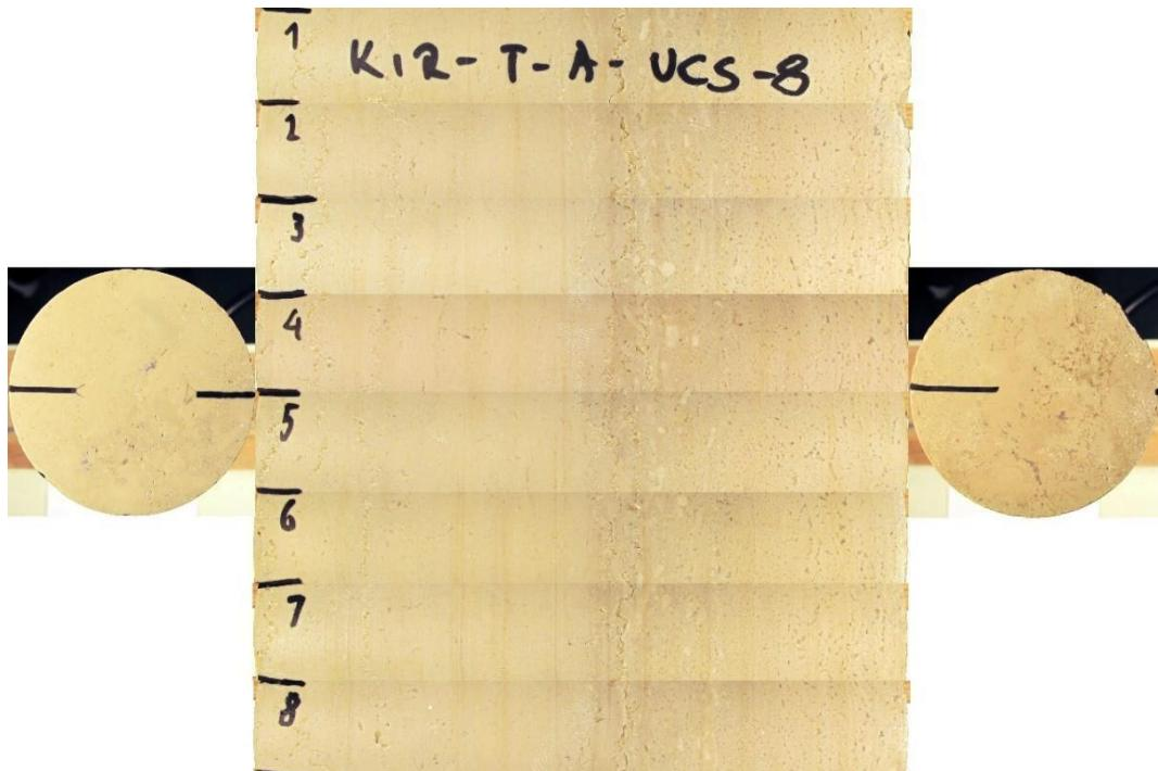
Slika 4.3 Razvijen plašt uzorka tamnog varijeteta Kirmenjaka laboratorijske oznake KIR-T-A-UCS-8. Na uzorku se vidi laminacija, kao prijelaz iz tamnog prema svjetlom varijetu kirmenjaka. Na plaštu su vidljivi stilolitski šavovi koji su paralelni s bazama. Vidljive su i onkoidi te kalcitna zrna.
