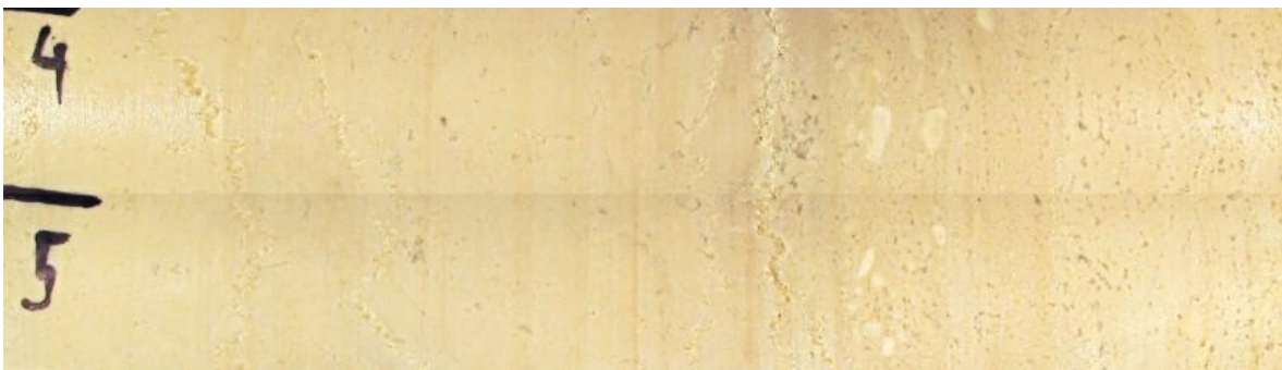
Slika 5.2 Uvećani plašt uzorka KIR-T-A-UCS-2, čiji je intenzitet raspucanosti okarakteriziran kao slab.
