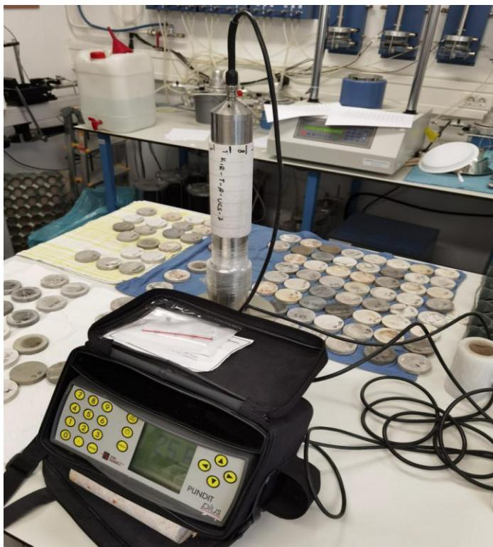
Slika 3.5 Mjerenje vremena prolaska ultrazvučnih valova.
