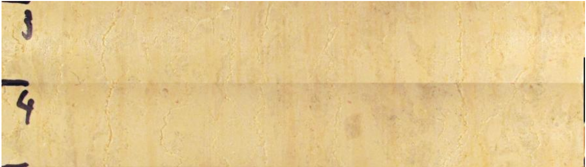
Slika 5.7 Uvećanje plašta uzorka KAN-IV-A-UCS-11, čiji je intenzitet raspucanosti okarakteriziran kao umjeren.
