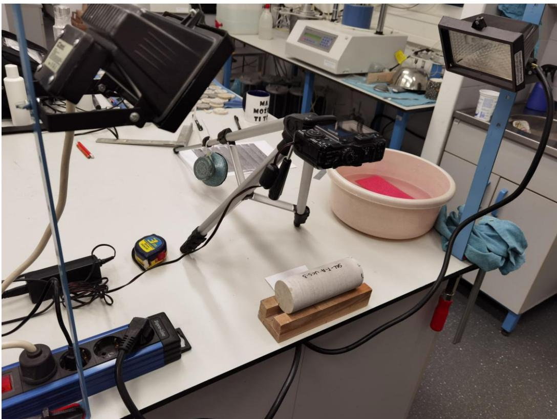
Slika 3.4 Aparatura za slikanje uzorka.
