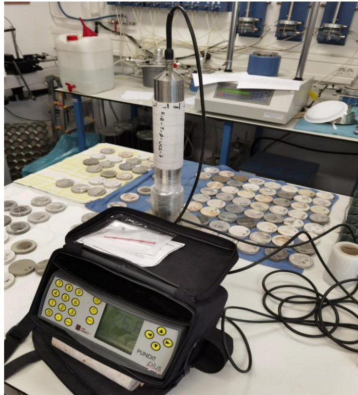
Slika 3.5 Mjerenje vremena prolaska ultrazvučnih valova.
