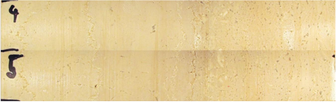
Slika 5.3 Uvećanje plašta uzorka KIR-T-A-UCS-3, čiji je intenzitet raspucanosti okarakteriziran kao umjeren.
