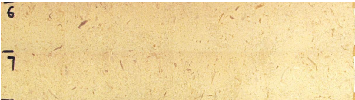
Slika 5.11 Uvećanje plašta uzorka VAL-U-A-UCS-7, no kome nisu uočeni defekti.
