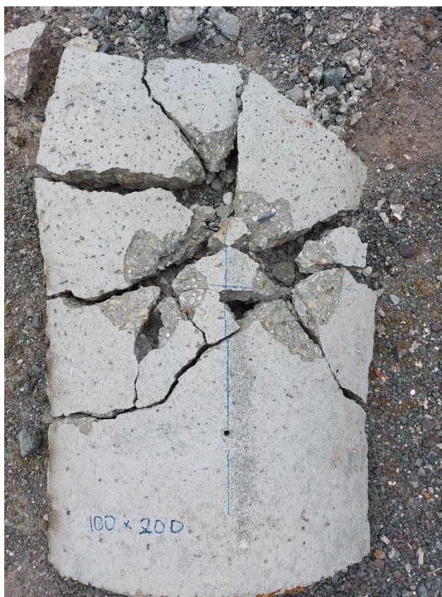
Slika 8-3. Ishod miniranja koristeći trokutasti raspored 100 mm x 200 mm
