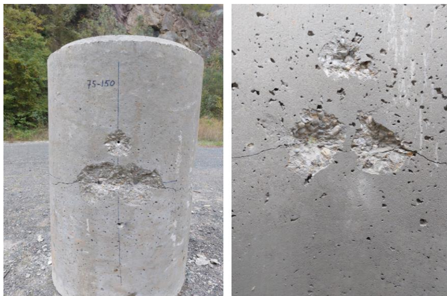
Slika 8-7. Učinak naboja koristeći raspored 75 mm x 150 mm
