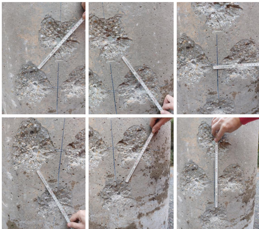
Slika 8-6. Mjerenje duljine razmaka između kratera
