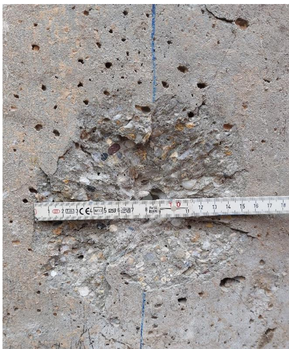
Slika 8-5. Mjerenje radijusa ljevkastog i čistog odloma
