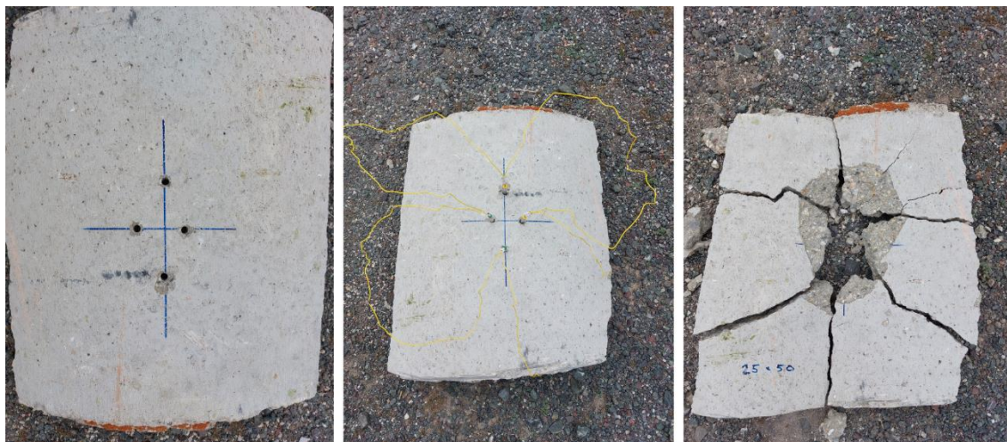
Slika 8-1. Redosljed radnji prilikom miniranja
