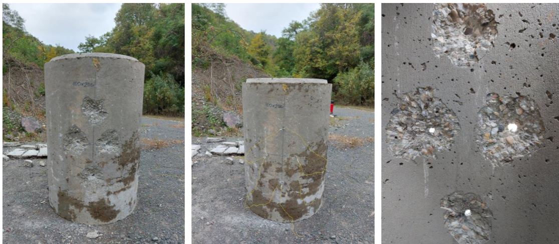
Slika 8-4. Betonska cijev prije i nakon miniranja
