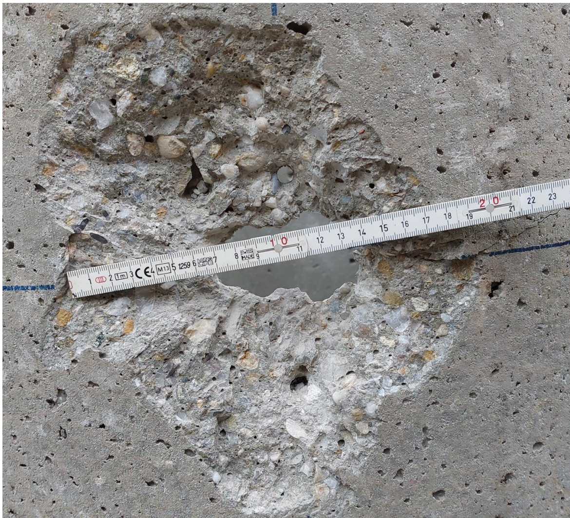
Slika 8-9. Učinak naboja koristeći raspored 25 mm x 50 mm
