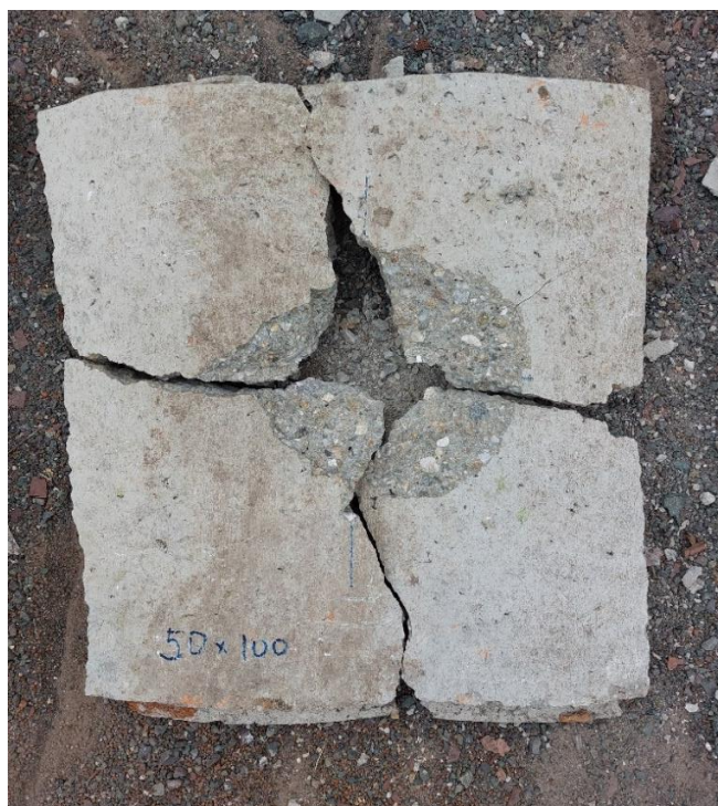
Slika 8-2. Ishod miniranja koristeći trokutasti raspored 50 mm x 100 mm
