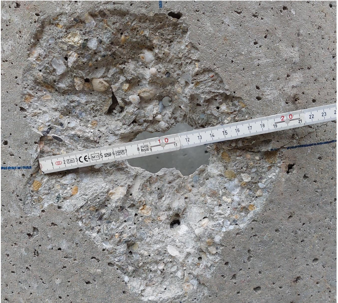
Slika 8-9. Učinak naboja koristeći raspored 25 mm x 50 mm
