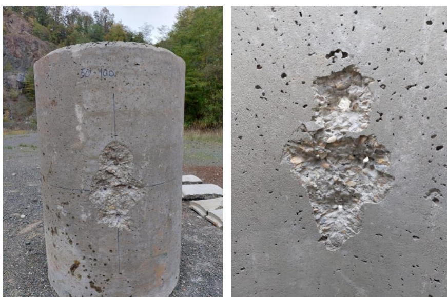
Slika 8-8. Učinak naboja koristeći raspored 50 mm x 100 mm
