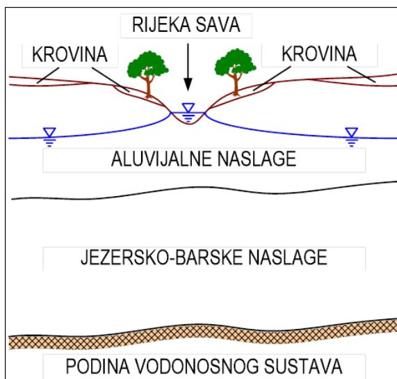
Slika 4-1. Shematski profil zagrebačkog vodonosnog sustava (Posavec, 2006)
