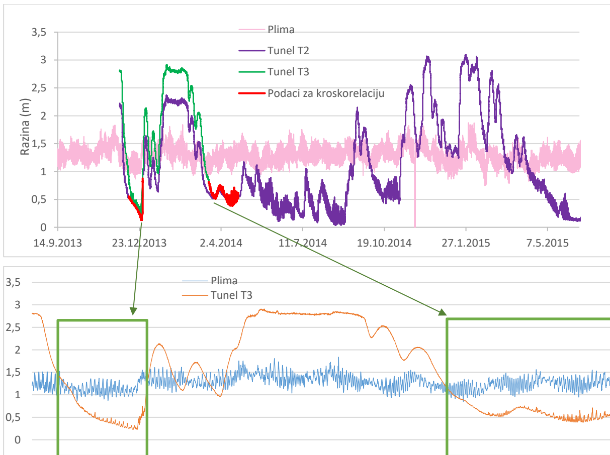
Slika 84. Kolebanje razine mora i razine jezera mjerene automatskim mjeracima na ulazu (Tunel T2) i izlazu iz Baćinskih jezera (Tunel T3). Zelenim pravokutnicima su naznačena dva razdoblja razina korištena prilikom analiza.
