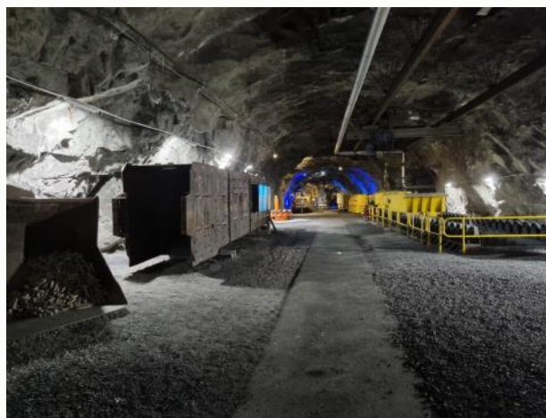
Na lijevoj strani je horizontalno položen „skip“ koji se koristi za transport rude kroz vertikalna i koso nagnuta okna, a na desnoj strani je žuto obojeni vagon s pomičnim dnom koji se koristi za transport rude od mjesta kopanja do mjesta utovara u „skipove“
