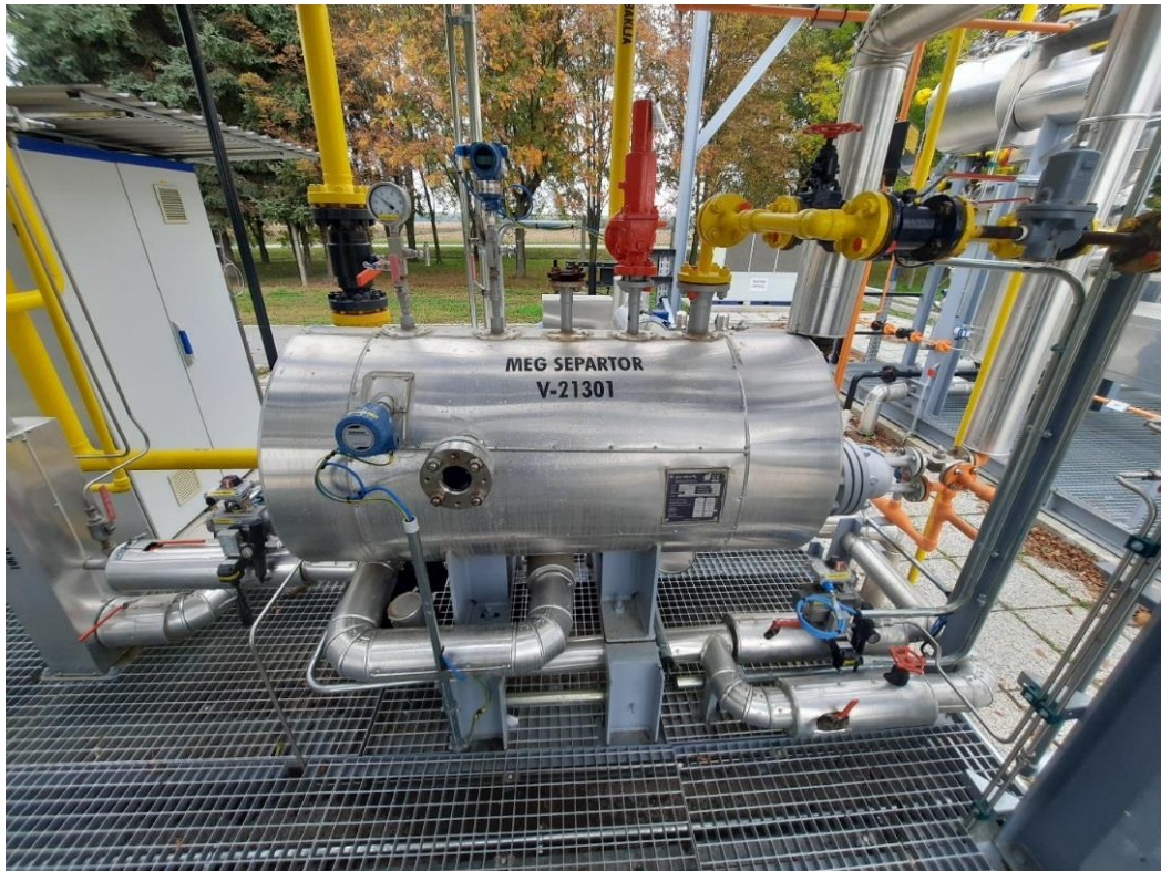
Slika 4-11. Separator za izdvajanje monoetilenglikola
