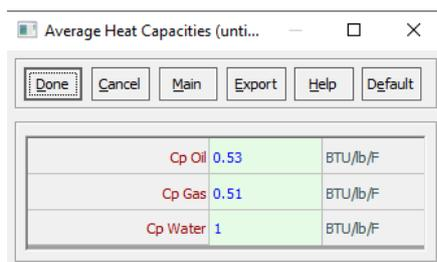
**Slika 4-9.** Specifične topline fluida u bušotini X
