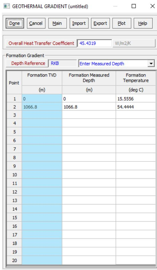
**Slika 4-8.** Geotermalni gradijent u bušotini X
