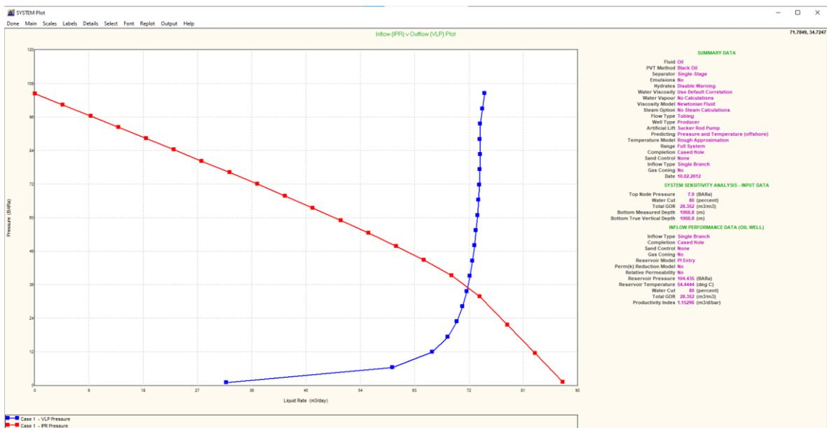
**Slika 4-14.** Radna točka proizvodnog sustava bušotine X
