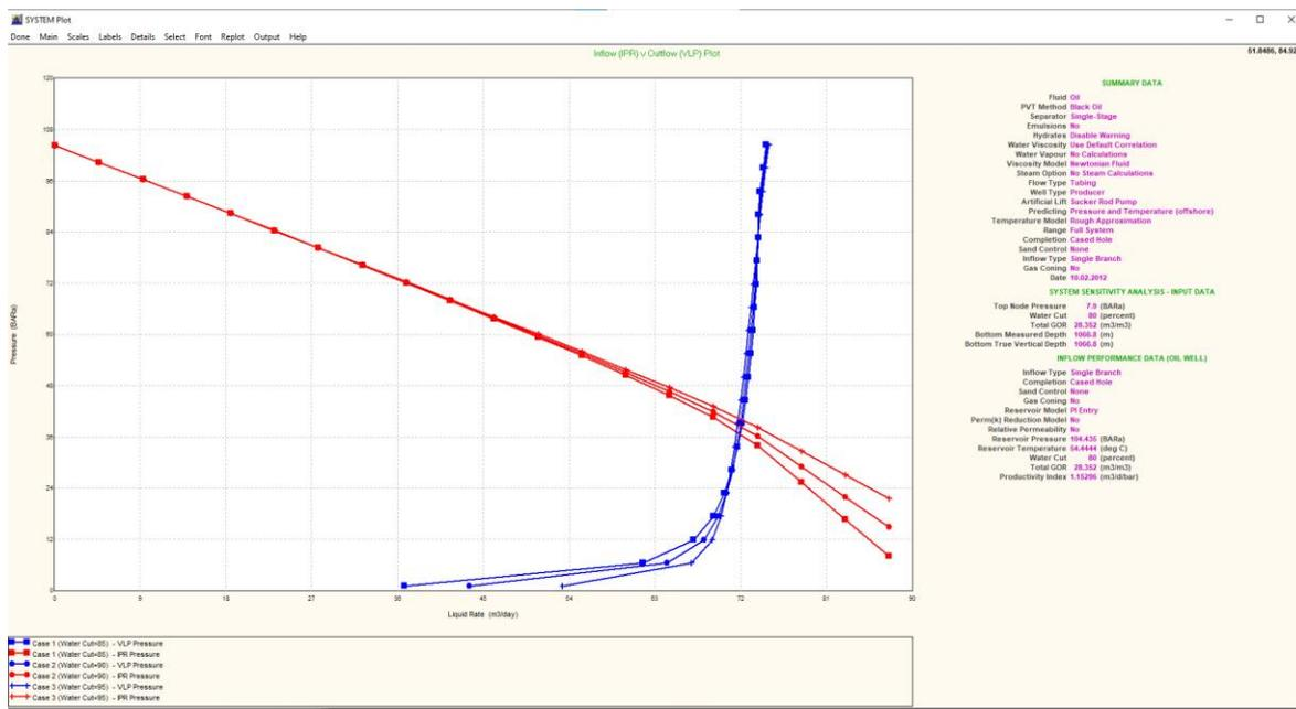
**Slika 4-17.** Prognoziranje rada bušotine X prema analizi osjetljivosti
