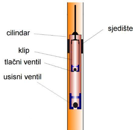
**Slika 2-2.** Dijelovi crpke s klipnim šipkama (Brkić, 2018)
