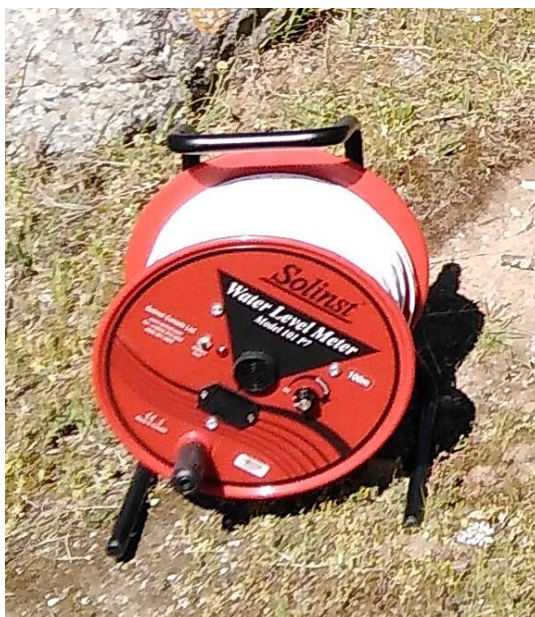
Slika 4-2. Ručni mjerač razine podzemne vode
