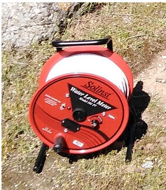
**Slika 4-2.** Ručni mjerač razine podzemne vode
