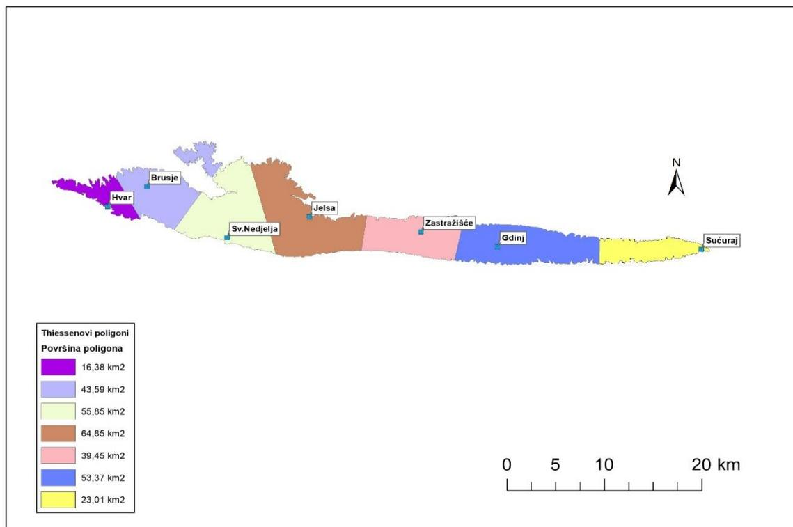
**Slika 5-4.** Prostorni raspored utjecajnih površina pojedine kišomjerne postaje
