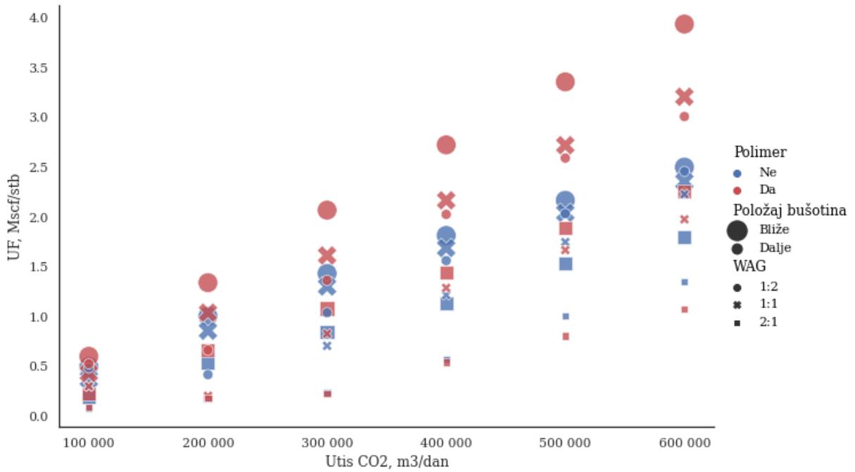
Slika 4-9. Dijagram ovisnosti faktora iskorištenja o brzini utiskivanja CO<sub>2</sub>
