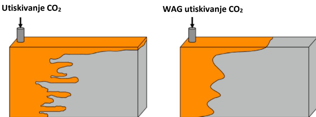
Slika 2-4. Shematski prikaz usporedbe kontinuiranog utiskivanja CO<sub>2</sub> i WAG utiskivanja (preuređeno iz Massarweh i Abushaikha, 2020).
