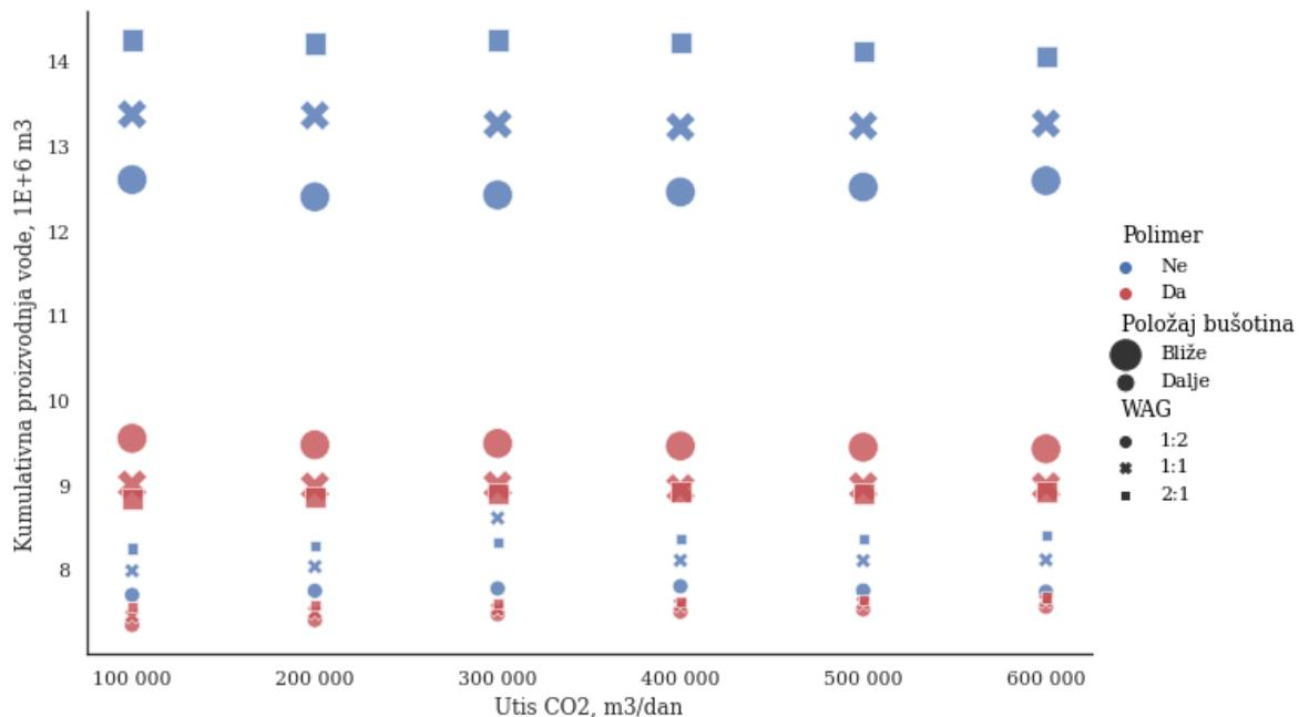
Slika 4-5. Dijagram kumulativne proizvodnje vode u ovisnosti brzine utiskivanja CO<sub>2</sub>
