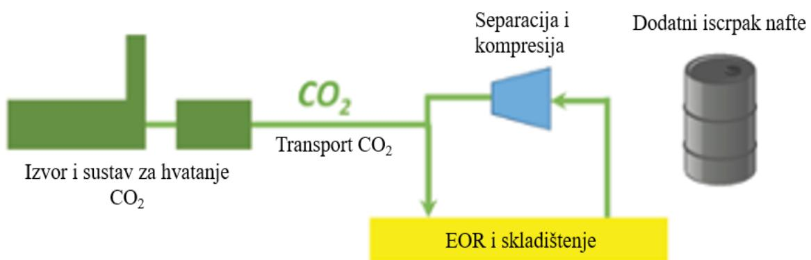
Slika 1-2. Pojednostavljeni prikaz CO<sub>2</sub> EOR procesa i skladištenja CO<sub>2</sub> (Scottish Carbon Capture & Storage, 2015)
