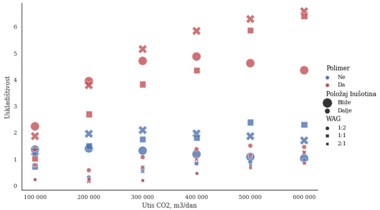
Slika 4-8. Dijagram uskladištvosti u ovisnosti o brzini utiskivanja CO<sub>2</sub>
