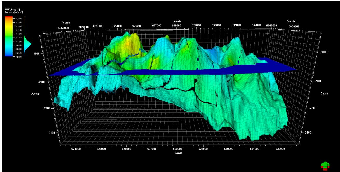
Slika 3-1. Prikaz poroznosti u ćelijama originalnog 3D modela
