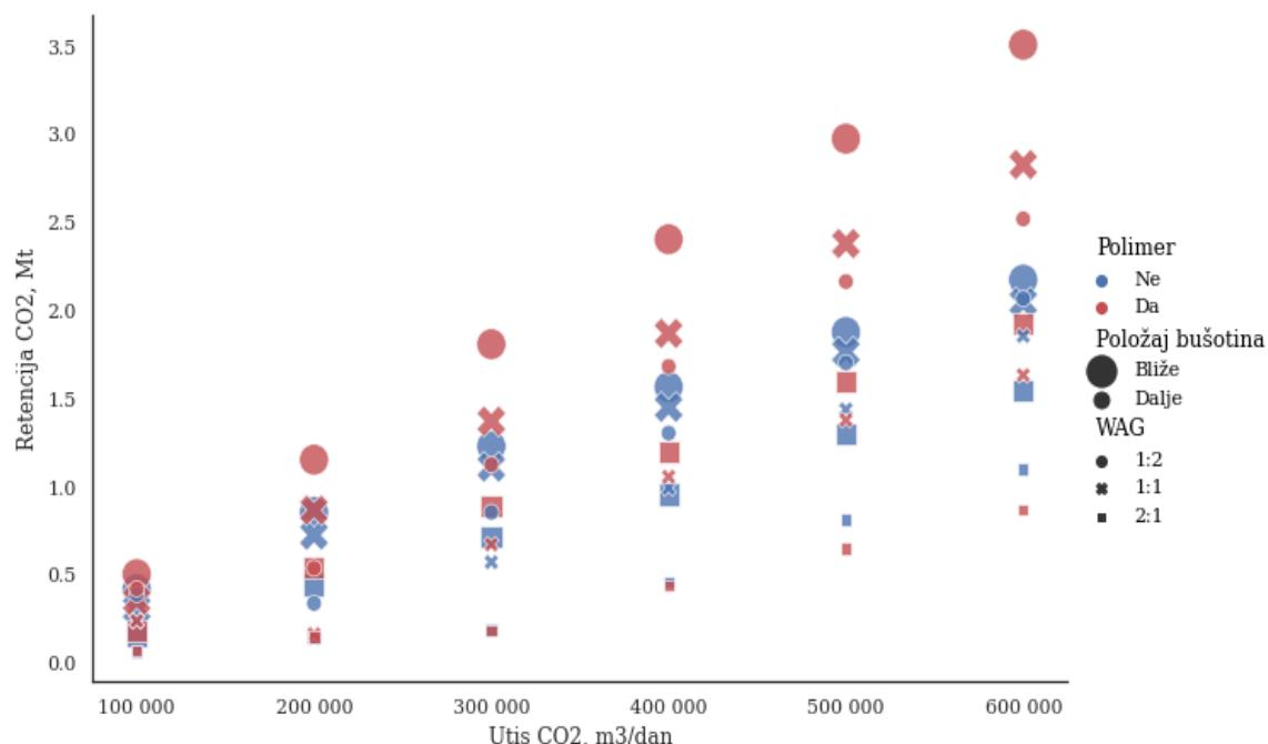
Slika 4-6. Dijagram retencije CO<sub>2</sub> u ovisnosti o brzini utiskivanja CO<sub>2</sub>
