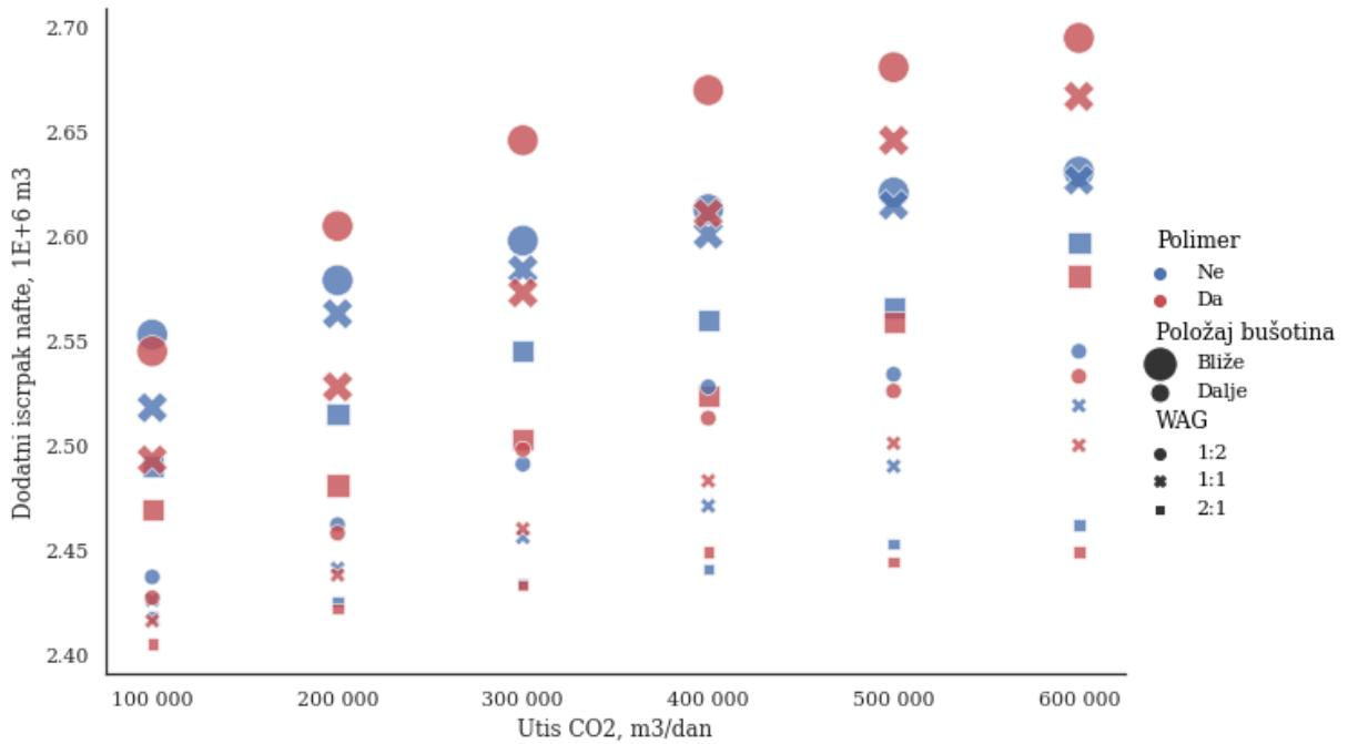
Slika 4-3. Dijagram ovisnosti dodatnog iscrpka nafte o brzini utiskivanja CO<sub>2</sub>
