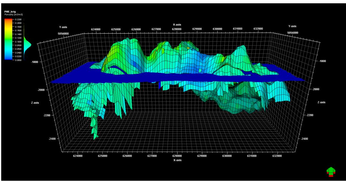
Slika 3-2. Prikaz poroznosti u ćelijama homogeniziranog 3D modela
