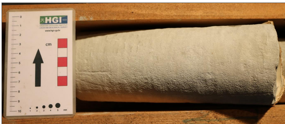
Slika 37. Izgled jezgre masivnog sitnozrnatog i srednjezrnatog pješčenjaka.
