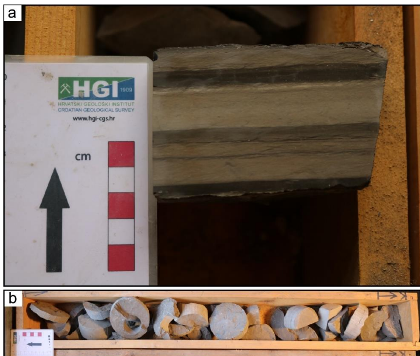
Slika 34. Primjer bušotinskog facijesa 1. a) dio jezgre; b) fragmentirani uzorci jezgre.
