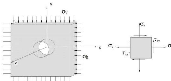
**Slika 4-3.** Ploča s kružnim otvorom beskonačne dubine (Hrestak, 2010)
