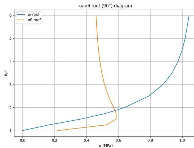
**Slika 5-33.** Naprezanja u kaloti tunela - RockStressCalc
