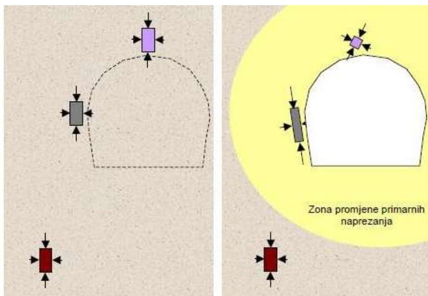
**Slika 4-2.** Primarno i sekundarno polje naprezanja (Vrkljan, 2013)
