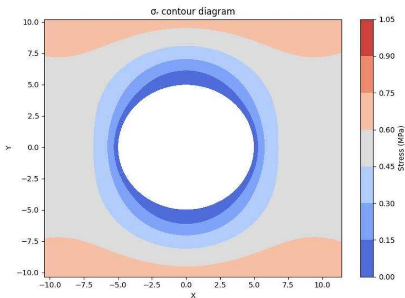
**Slika 5-21.** Radijalno naprezanje za  $\theta = 0^\circ$  - RockStressCalc
