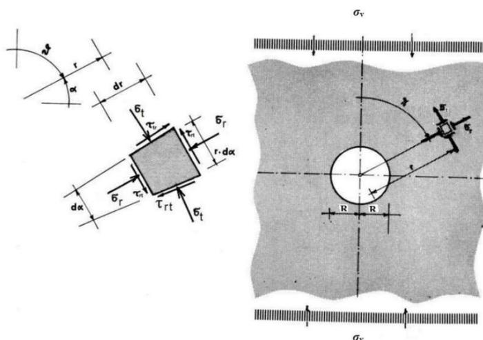
Slika 4-4. Model za slučaj djelovanja vertikalnog naprezanja (Frgić, 2013)
