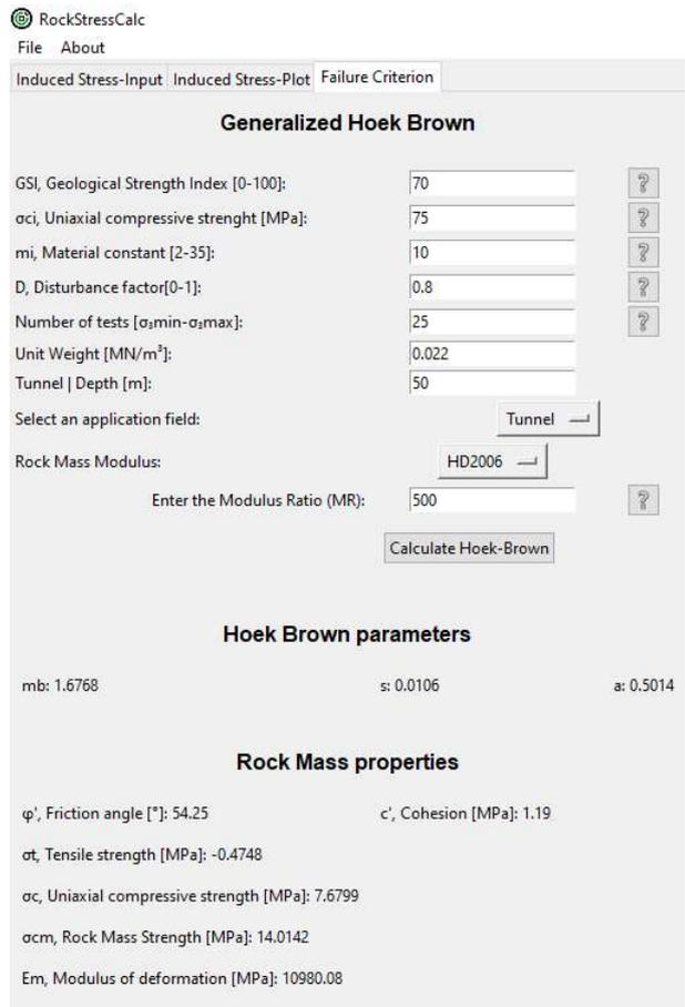
Slika 5-35. Ulazni i izlazni podaci proračuna čvrstoće – RockStressCalc
