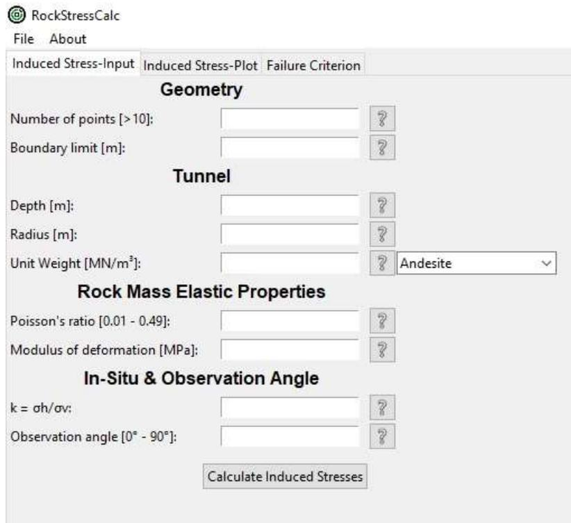
Slika 5-2. Ulazni parametri sekundarnih naprezanja i pomaka
