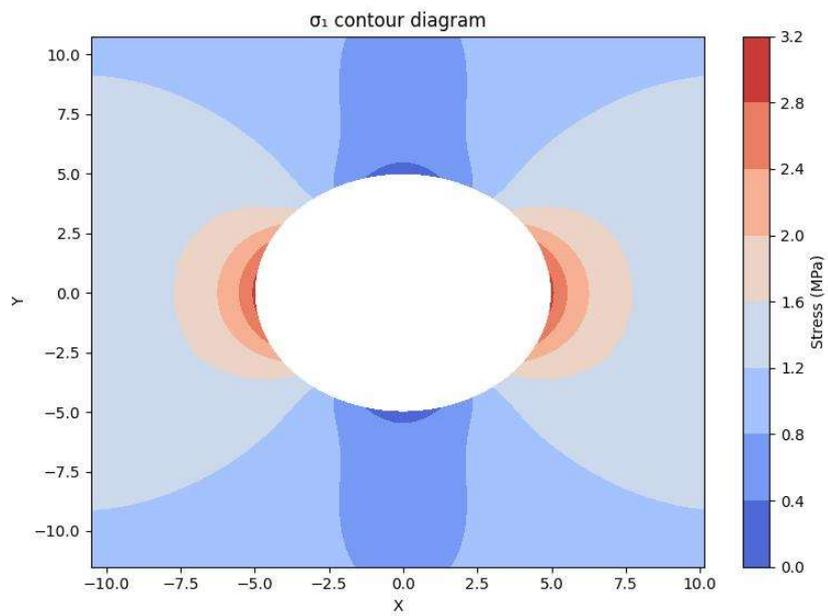
Slika 5-24. Veće glavno naprezanje za  $\theta = 0^\circ$  - RockStressCalc
