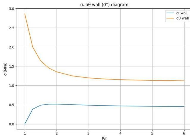
Slika 5-34. Naprezanja u zidu tunela - RockStressCalc
