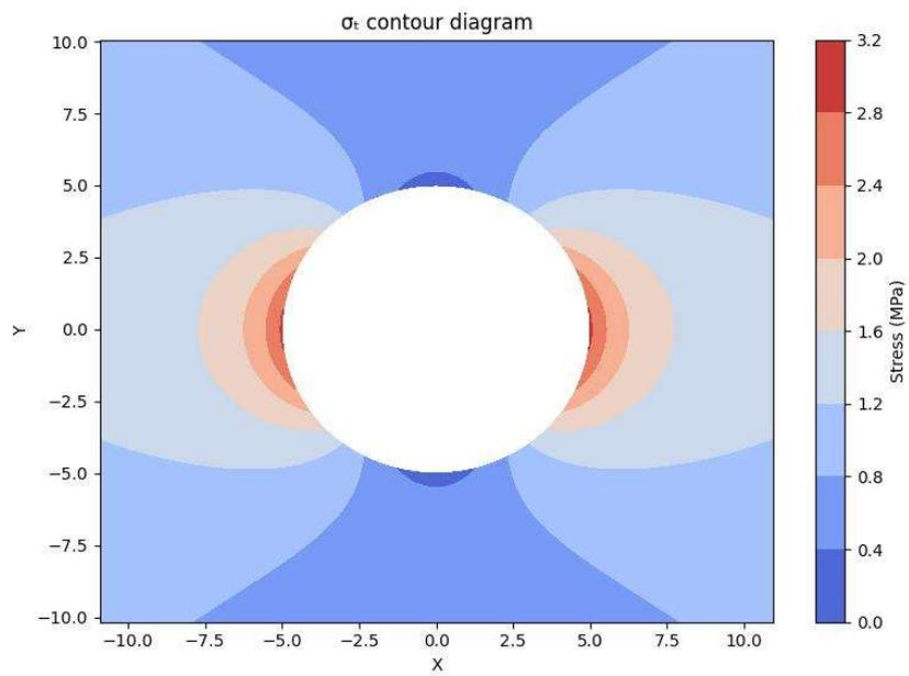
Slika 5-22. Tangencijalno naprežanje za  $\theta = 0^\circ$  - RockStressCalc
