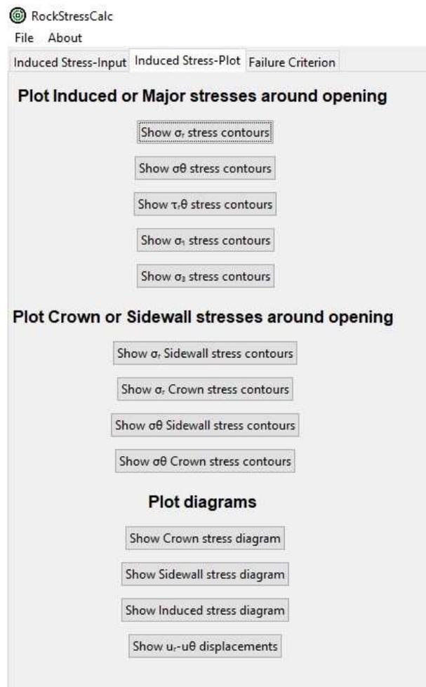
Slika 5-4. Mogućnosti prikaza sekundarnih naprezanja i pomaka
