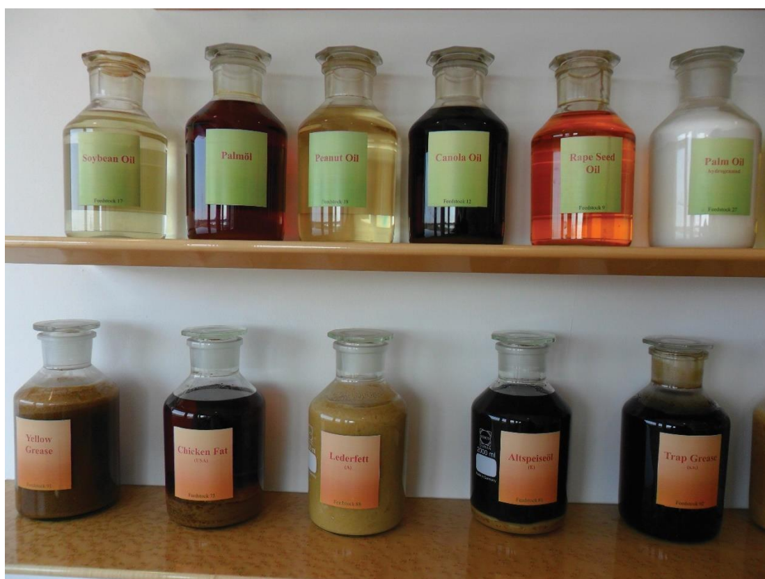
Slika 4-1. Prikaz različitih sirovina za proizvodnju biodizel (sojino ulje, palmino ulje, ulje od kikirikija, ulja od kanole, repičino ulje, hidrogenirano palmino ulje, žuta mast, pileća mast, životinjska mast, otpadno ulje za kuhanje, uhvaćena mast kuhanja) (Kovač, 2020)
