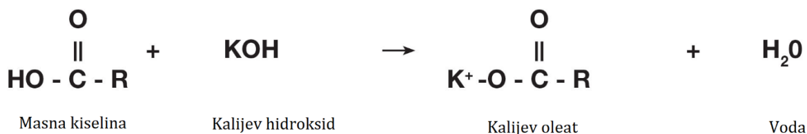
Slika 5-2. Kemijska formula procesa dodavanja alkalnog katalizatora (izrađeno prema Kovač, 2020)
