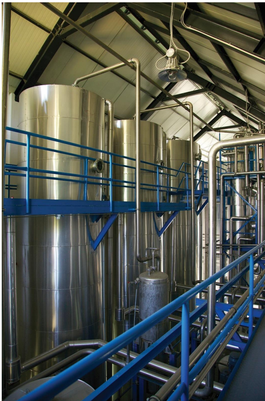
Slika 6-4. Reaktori u postrojenju za proizvodnju biodizela (Kovač, 2020)
