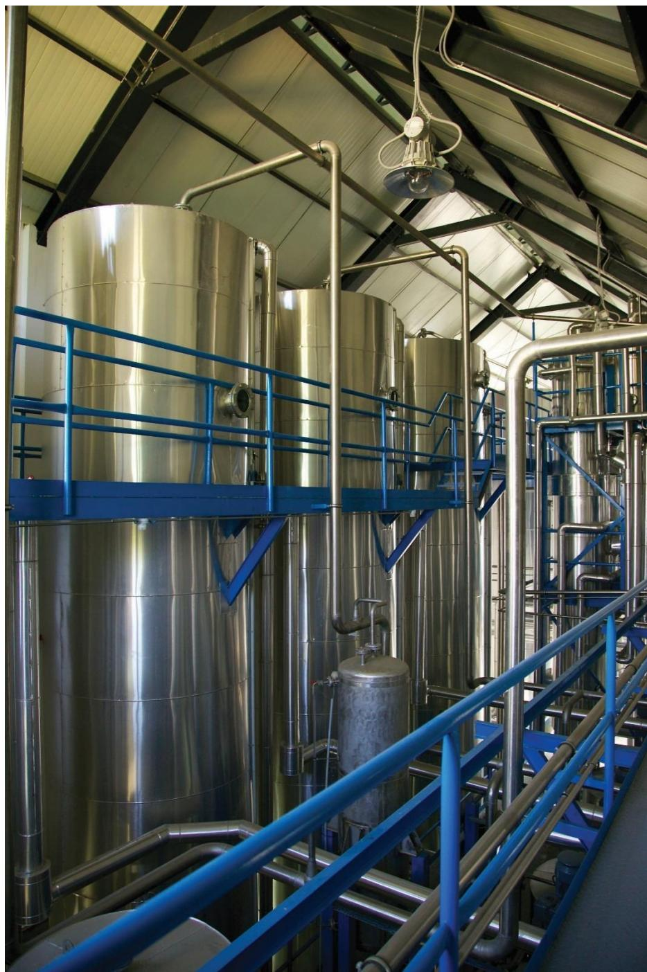
**Slika 6-4.** Reaktori u postrojenju za proizvodnju biodizela (Kovač, 2020)
