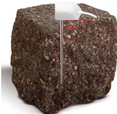
Slika 5.1. Ispravno postavljena sonda u stijenskoj masi
