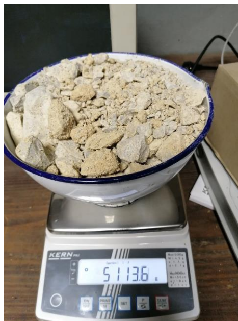
Slika 4.16. Određivanje mase uzorka na elektronskoj vagi
