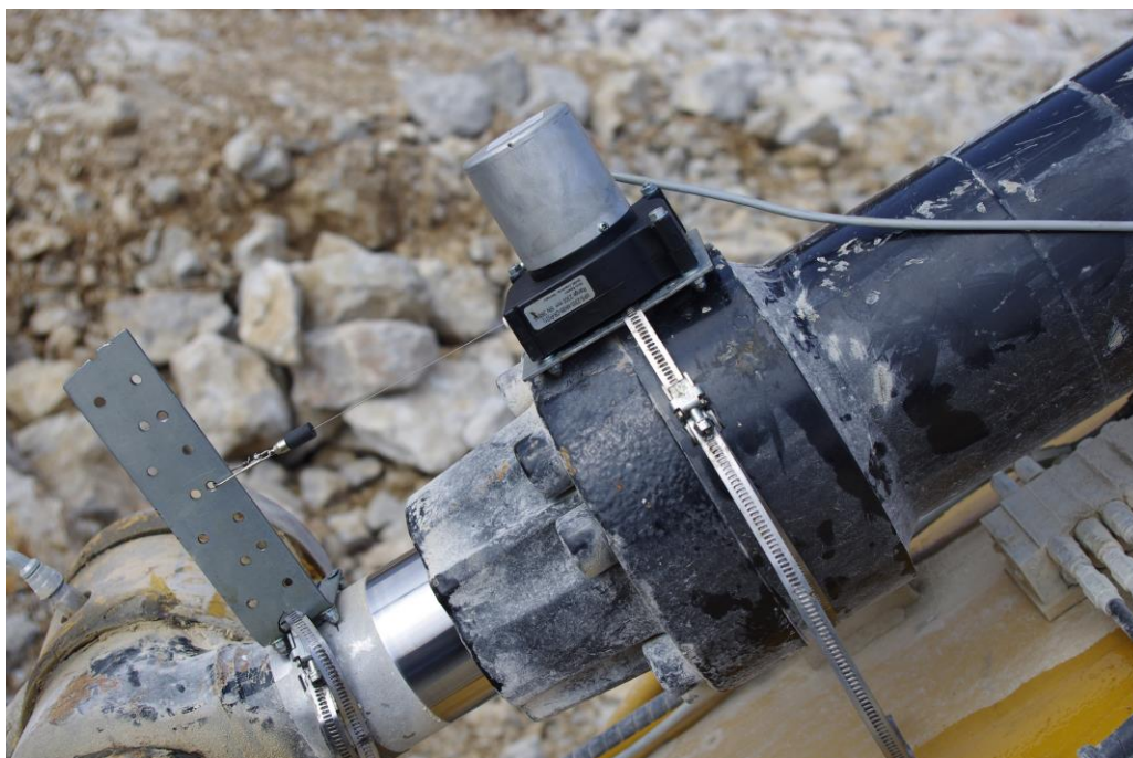
Slika 4.2. Ugradnja linearnoga mjernog pretvornika položaja.
