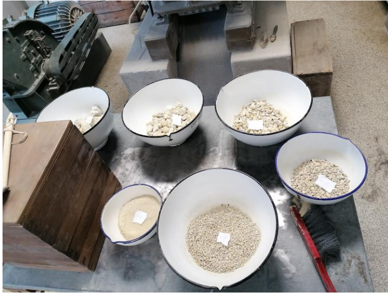
Slika 4.17. Određivanje granulometrijskoga sastava nekoherentnih materijala
