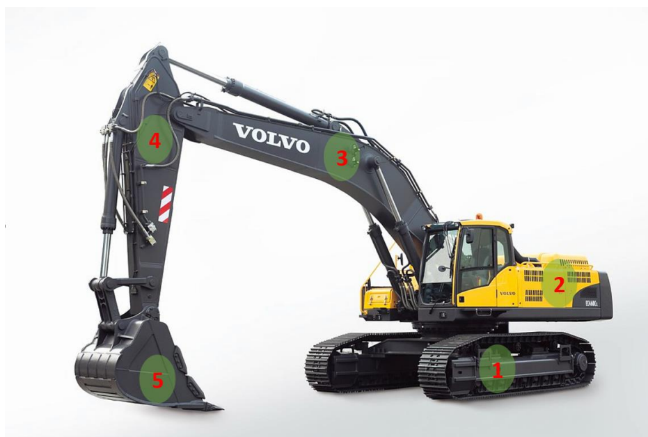
Slika 3.1. Hidraulični bager s dubinskom lopatom (Flickr, 2023)
