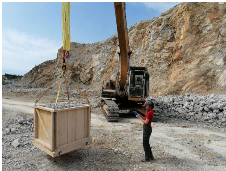
Slika 4.13. Terensko određivanje nasipne gustoće
