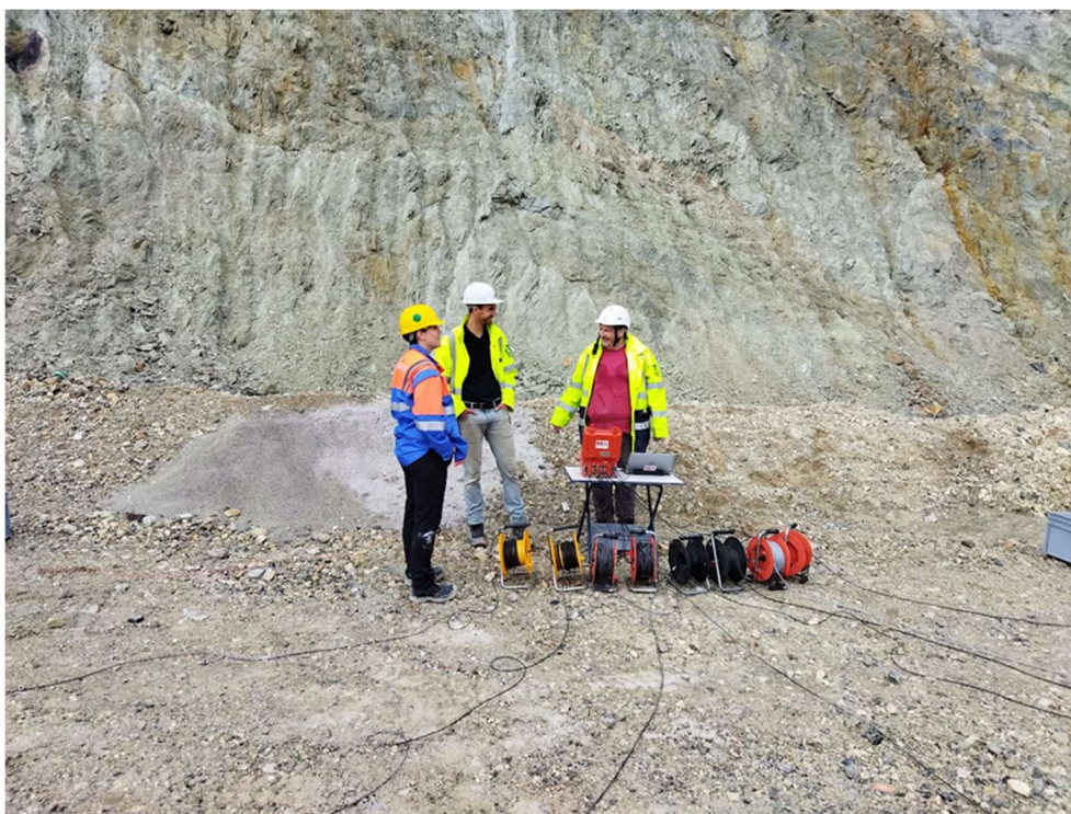
Slika 6-2. Mjerenje brzine detonacije na 8 bušotina
