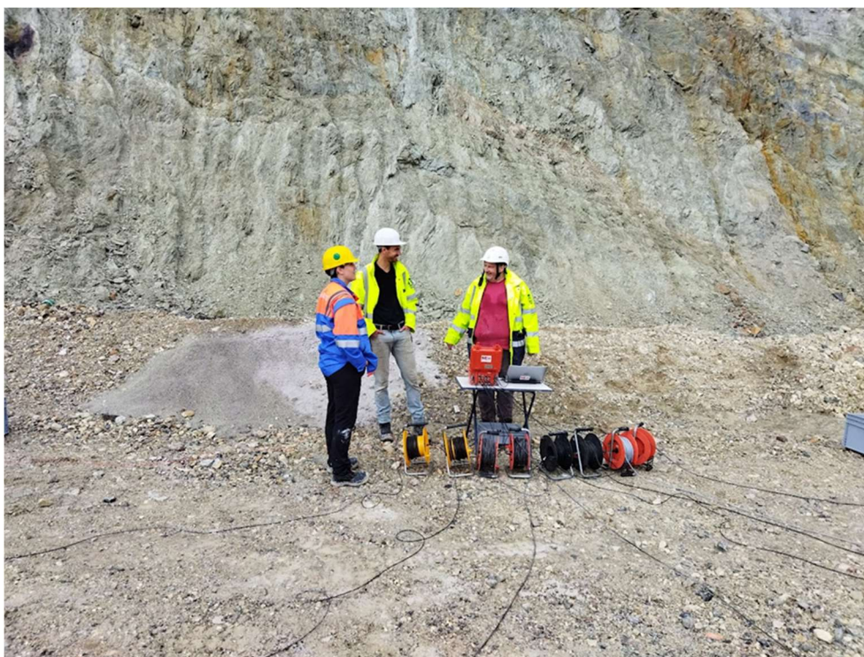
Slika 6-2. Mjerenje brzine detonacije na 8 bušotina
