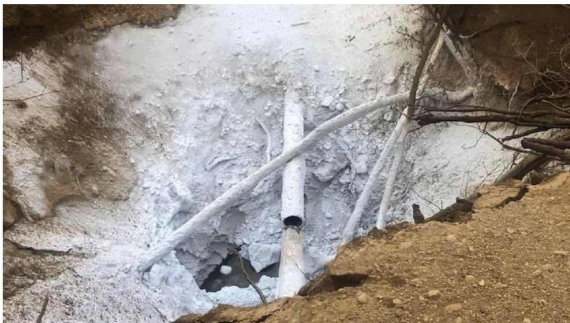
Slika 5-4. Istjecanje CO 2 uslijed puknuća cjevovoda i smrzavanje uzrokovano Joule Thomson-ovim efektom (Capello et al., 2022)
