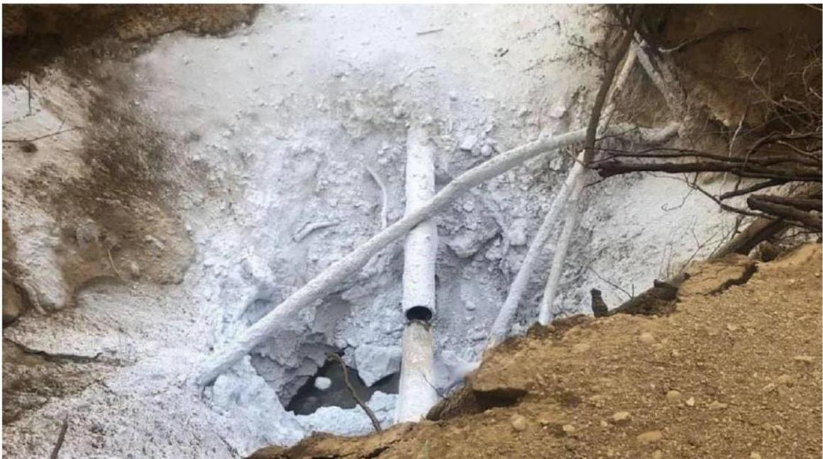
**Slika 5-4.** Istjecanje CO<sub>2</sub> uslijed puknuća cjevovoda i smrzavanje uzrokovano Joule Thomson-ovim efektom (Capello et al., 2022)
