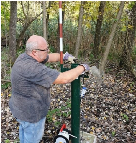
Slika 3.10. Piezometar PPKR-7 (Duić i dr., 2021)
