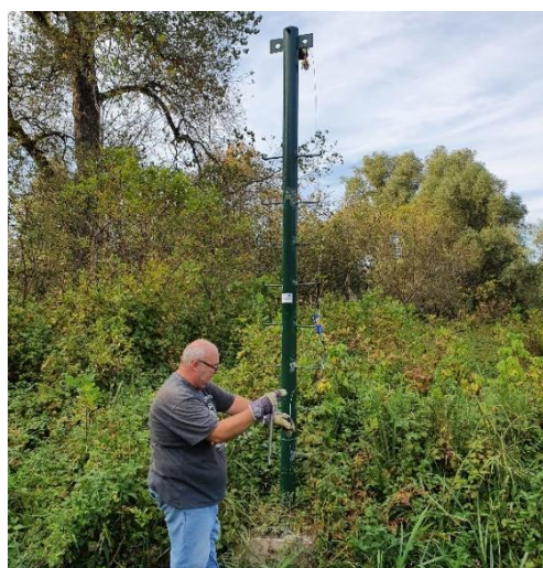
Slika 3.7. Piezometar PPKR-4 (Duić i dr., 2021)
