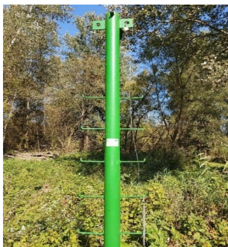
Slika 3.5. Piezometar PPKR-2 (Duić i dr., 2021)
