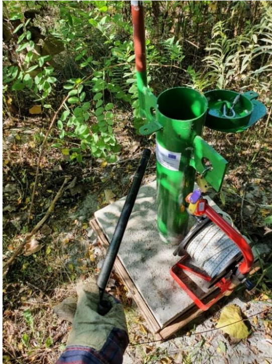
Slika 3.4. Piezometar PPKR-1 (Duić i dr., 2021)
