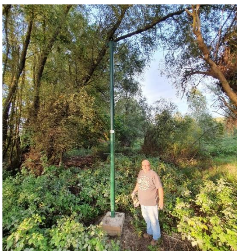
Slika 3.11. Piezometar PPKR-8 (Duić i dr., 2021)
