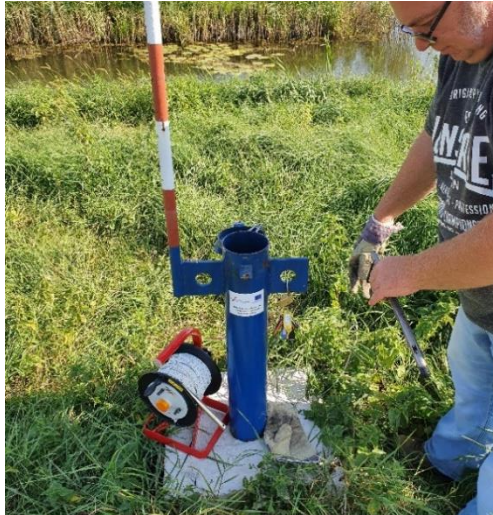
Slika 3.6. Piezometar PPKR-3 (Duić i dr., 2021)
