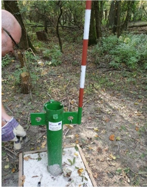
Slika 3.12. Piezometar PPKR-9 (Duić i dr., 2021)
