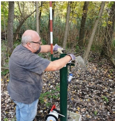
Slika 3.10. Piezometar PPKR-7 (Duić i dr., 2021)
