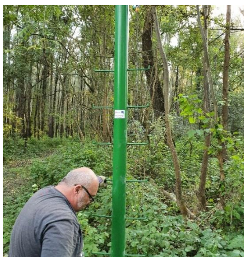
Slika 3.9. Piezometar PPKR-6 (Duić i dr., 2021)
