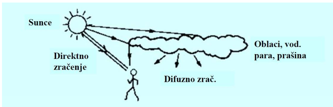
Slika 4-2. Ilustrativni primjer izravnog i difuznog solarnog zračenja (Dović, 2013)
