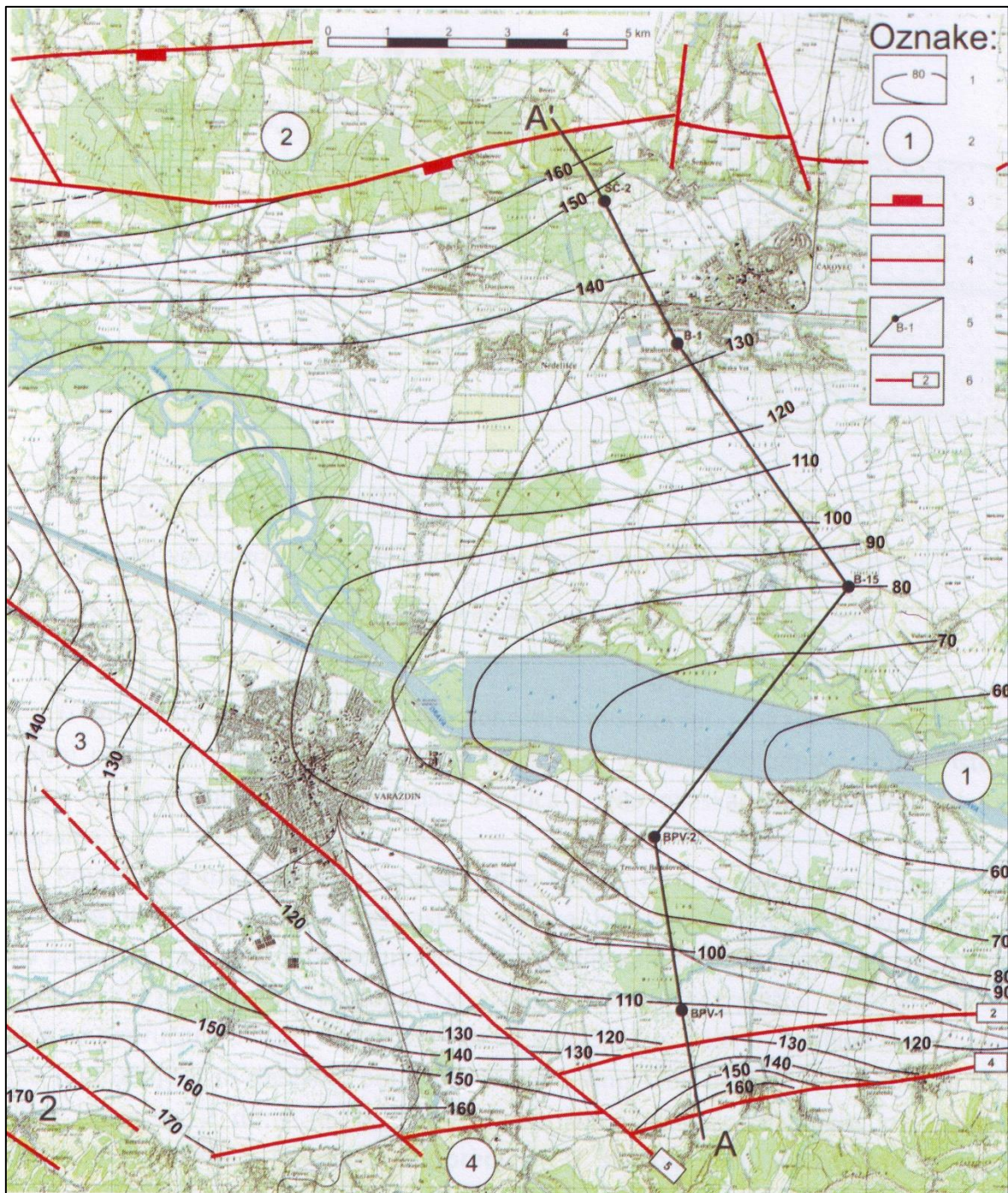
Slika 4-1. Strukturni zemljovid po podinskoj plohi vodonosnika (Urumović i dr., 1990); Oznake: 1- izohipse podine vodonosnika, 2 - strukture (1 - Varaždinska depresija, 2 - Ormož-Selnica, 3 - Ravna Gora, 4 - Ivanščica), 3 – rasjed s horizontalnim pomakom, 4 - rasjed bez oznake karaktera, 5 - trasa litološkog profila, 6 - važniji rasjedi strukturnog sklopa (1 - ormoški rasjed, 2 - južni rubni rasjed Murske potoline, 3 - rasjed duž sjevernog krila Ravne Gore, 4 - rasjed Sokolovac-Tužno-Ptuj, 5 - varaždinski rasjed)
