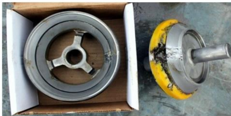
Slika7-2. Oštećenje sjedišta ventila pumpe (Bejger i Piasecki, 2013)
