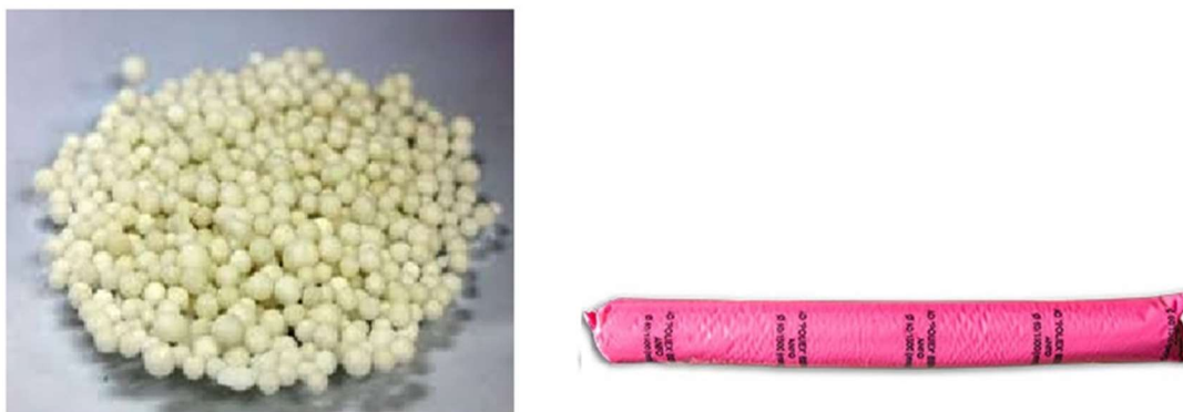
Slika 4-6. ANFO eksploziv (lijevo) (Zečić, 2015.) i patronirani ANFO eksploziv (desno) (POLIEX, 2021.).
