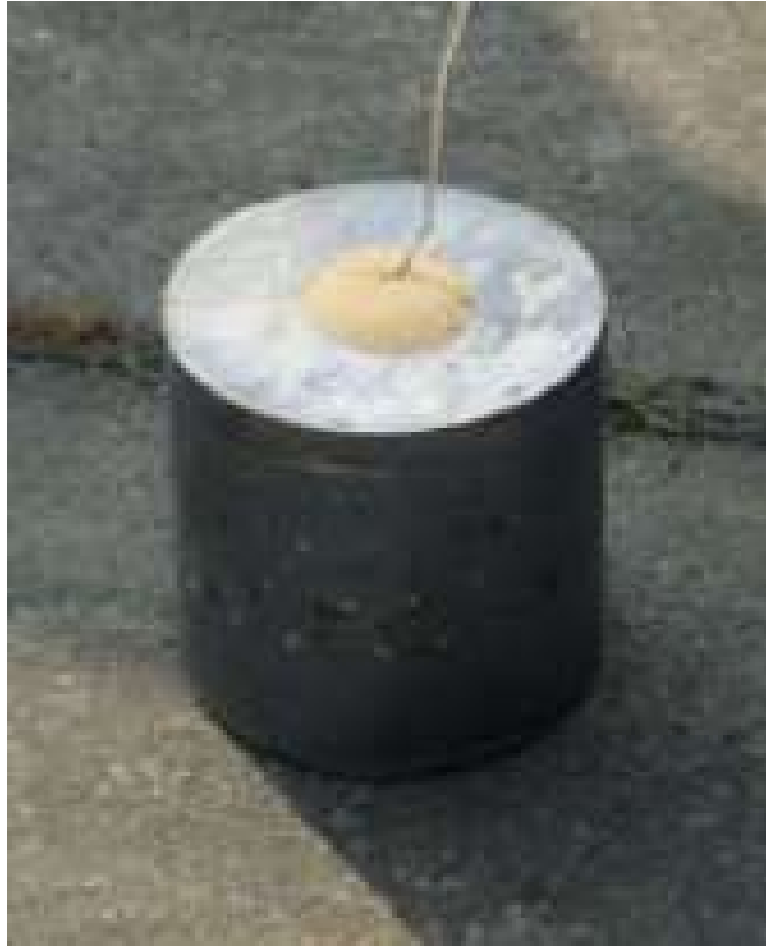
Slika 4-1. Olovni blok spreman za detonaciju. ( Memim encyclopedia, 2023 )
