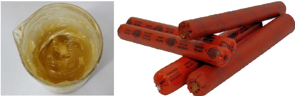
Slika 4-7. Emulzijska matrica (lijevo) (Zečić, 2015.) i emulzijski eksploziv (desno) (AUSTIN POWDER, 2023).
