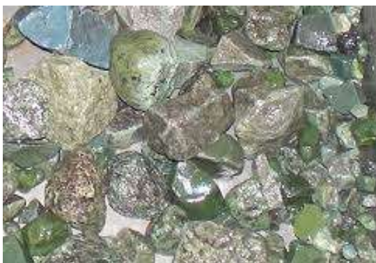
Slika 6-1. Silikomanganska troska (Izvor: Građevinar 63 (2011) 5, 441-447)
