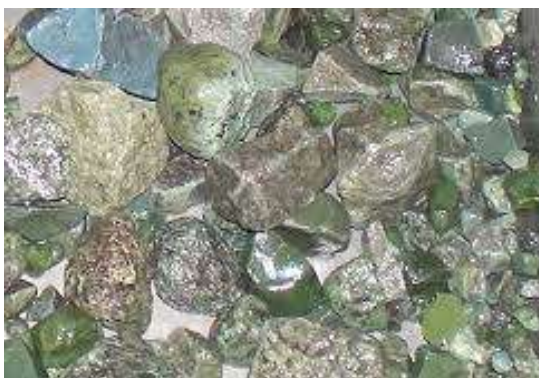
Slika 6-1. Silikomanganska troska (Izvor: Građevinar 63 (2011) 5, 441-447)
