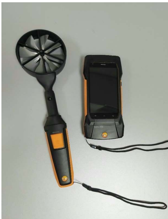
Slika 2-6. Krilna sonda i multifunkcijski mjerni uređaj TESTO 400
