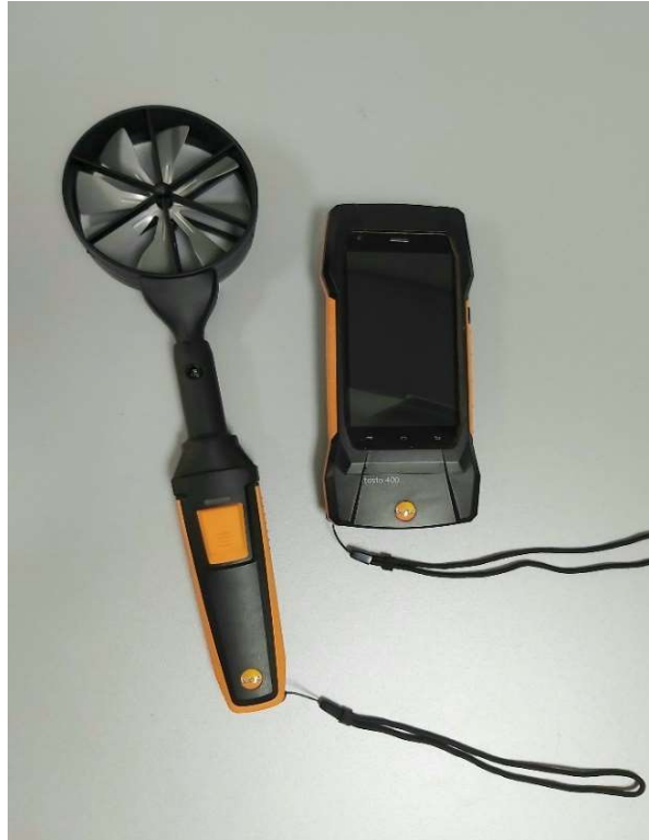
Slika 2-6. Krilna sonda i multifunkcijski mjerni uređaj TESTO 400
