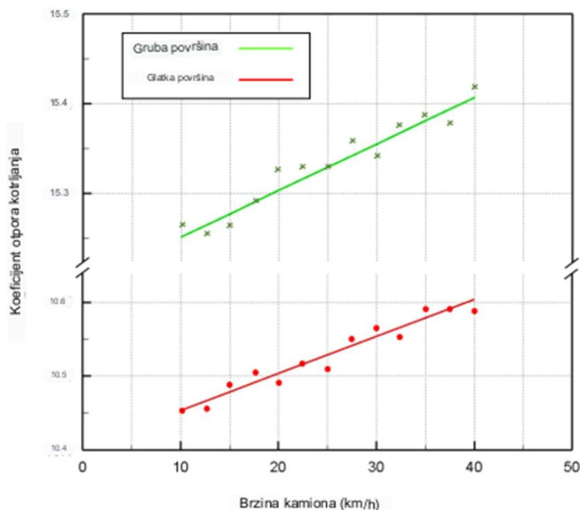
**Slika 4-2.** Odnos brzine kamiona i koeficijenta otpora kotrljanja kod hrapavih i glatkih površina (A.Soofastaei i sur.,2015.)
