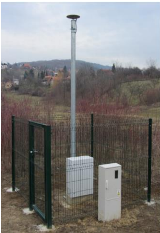
Slika 3-3 Jedna od 15 permanentnih GNSS stanica „Opservatorija za praćenje klizišta Kostanjek“ (Krkač, 2015)
