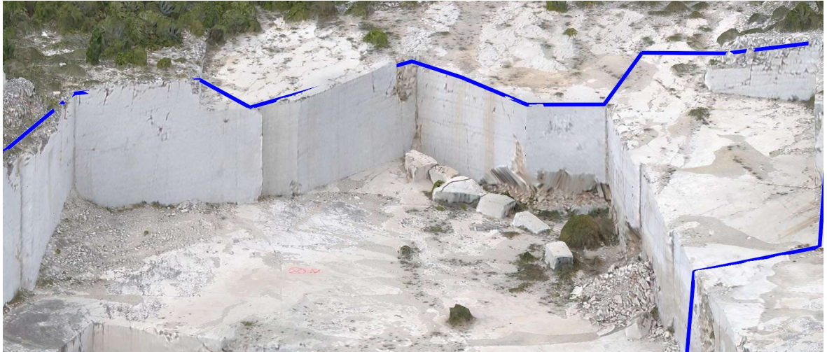
Slika 5-16. Prikaz trokutnog usjeka i kvalitetne stijenske mase
