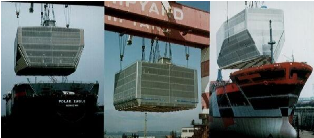
Slika 4-4. Različiti oblici spremnika prate oblik trupa broda (SPB Technology, n.d.)
