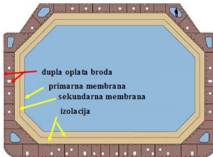
Slika 4-8. Poprečni presjek membranskog spremnika (Simon, 2023)
