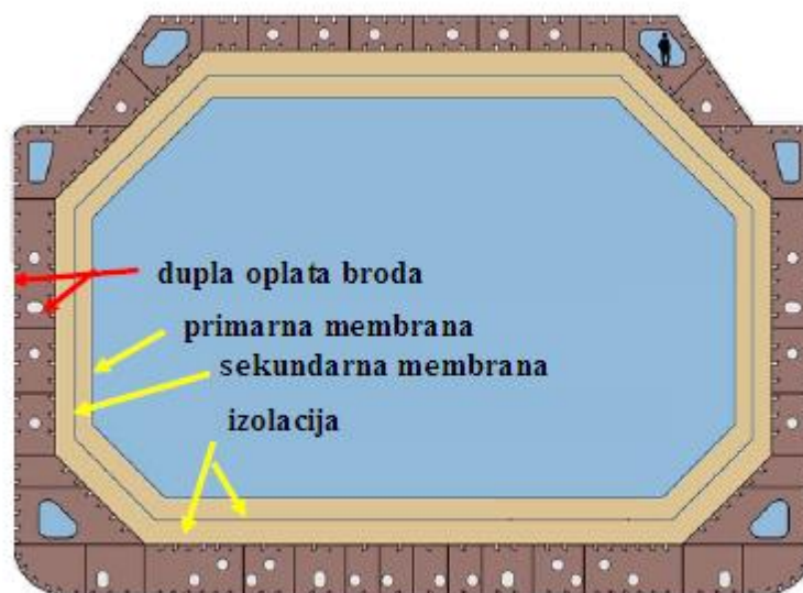
Slika 4-8. Poprečni presjek membranskog spremnika (Simon, 2023)
