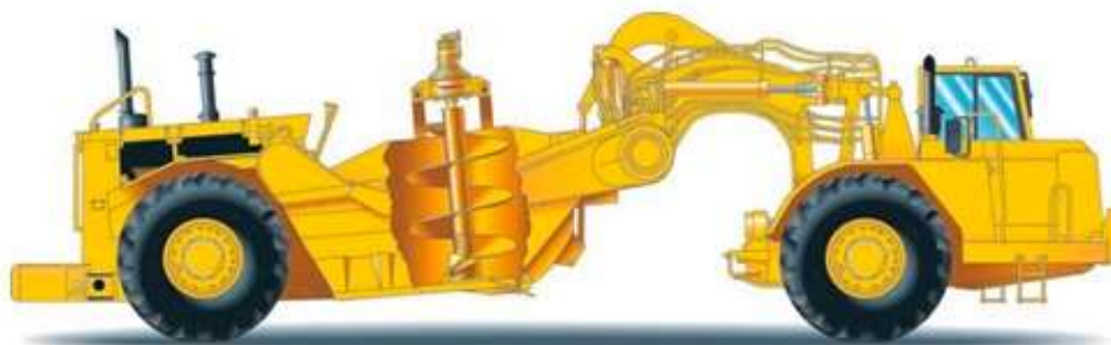
Slika 3-5. Skreper s pužnim transporterom
