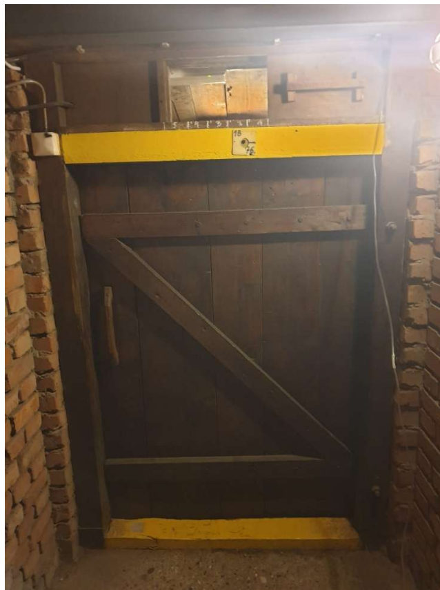
Slika 4-3. Vjetrena vrata s regulacijskim otvorom
